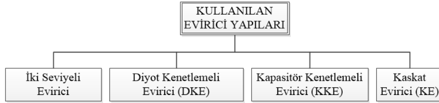
Şekil 3.1. Evirici yapılarının sınıflandırılması [79].
