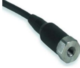
Şekil 3.12. Kesici takımın bulunduğu katere üç eksende (X,Y ve Z) monte edilen ivmeölçer.
