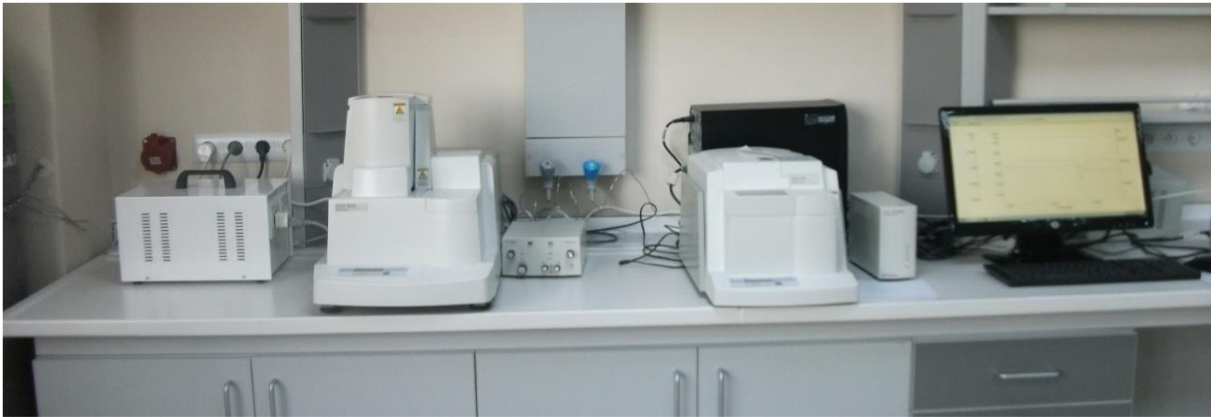
Şekil 2.10. Shimadzu DTG 60H-DSC 60 cihazı.
