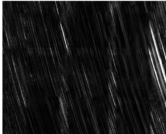
Şekil 7.15. 2 Nolu numunenin aşınan yüzeyinin mat alan görüntüsü.
