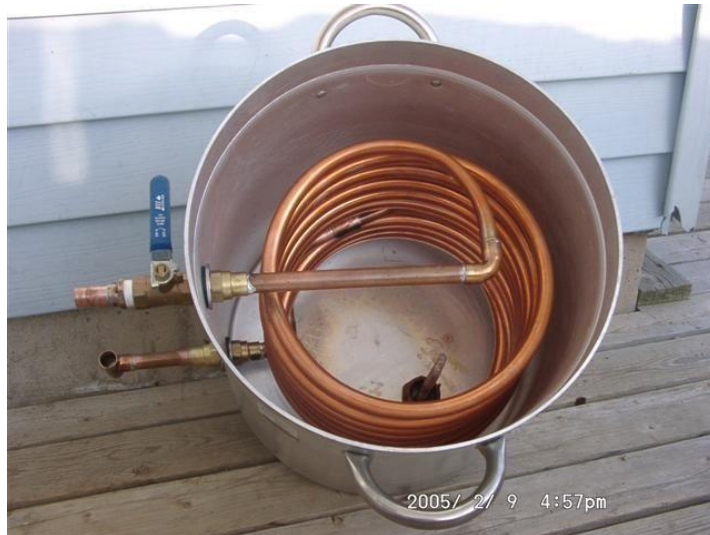
Şekil 1.9. Helisel borulu ısı eşanjör uygulaması.
