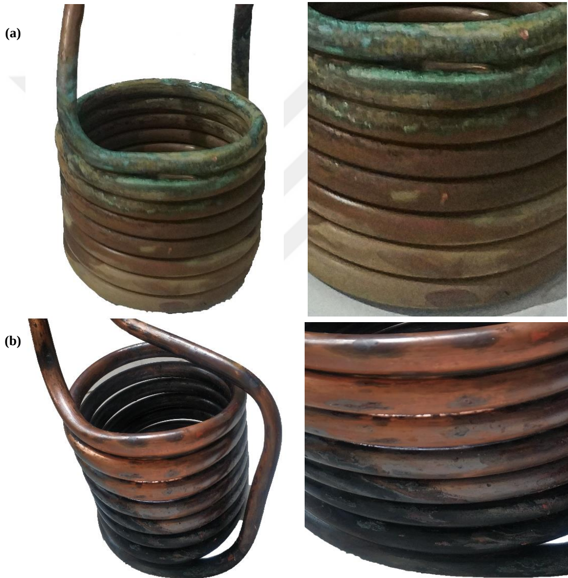
Şekil 3.10. 21 gün boyunca farklı ortamlarda korozyona maruz bırakılmış bakır serpantinler; (a) SCW, (b) SCW+NaNO 2 .
