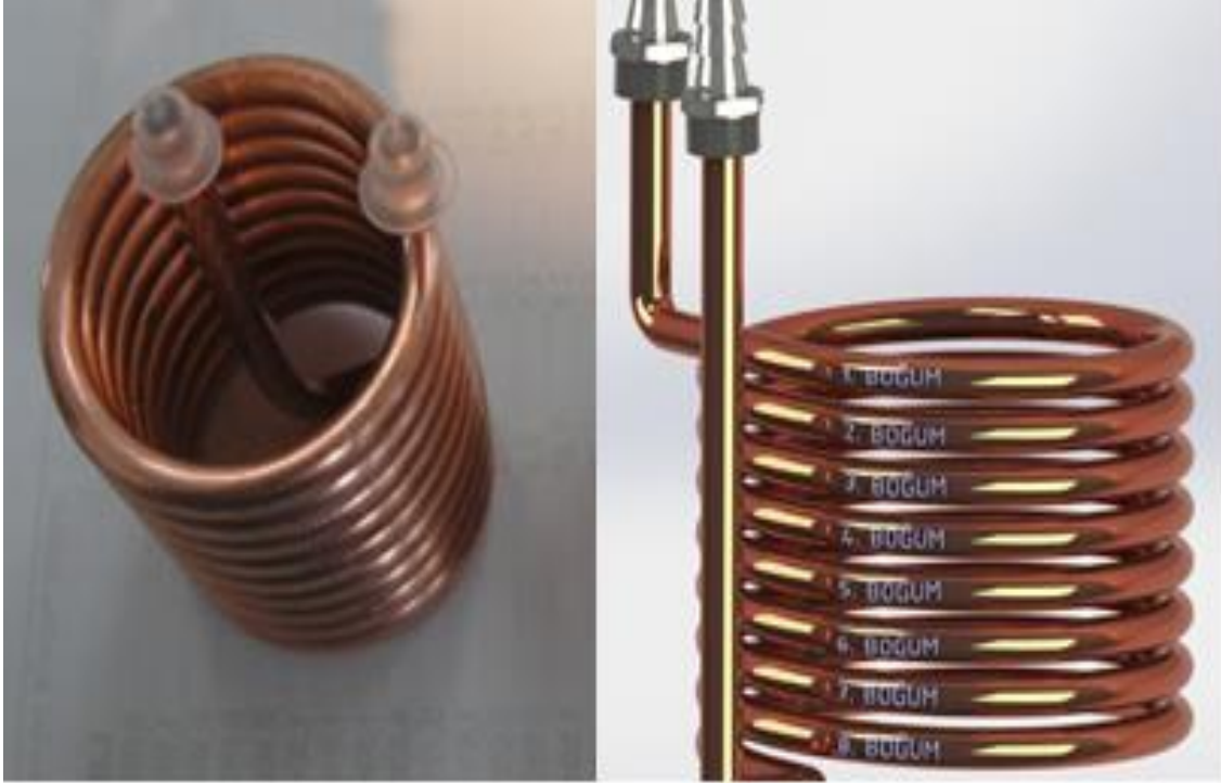
Şekil 2.1. Deneyde kullanılan bakır serpantin.
