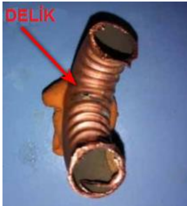
Şekil 1.15. Bakırda çukurcuk korozyonu.
