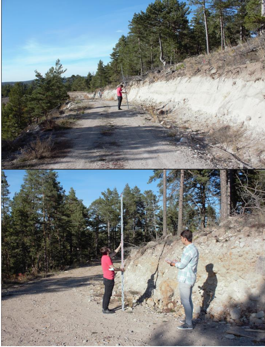
Şekil 2.15. Kazı şevi yüksekliklerinin ölçümü ve zemin klaslarının belirlenmesi.
