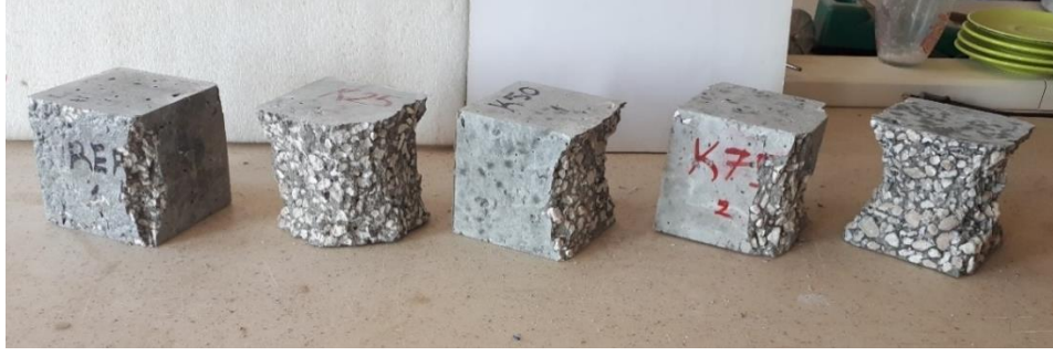
Şekil 2.11. Basınç dayanımı deneyinde kullanılan numune örnekleri
