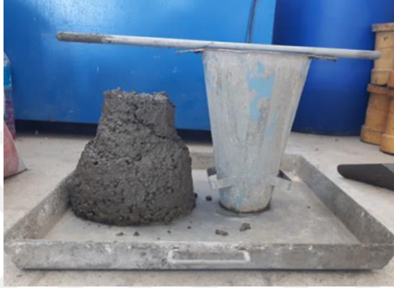
Şekil 2.7. Çökme deneyinin gerçekleştirilmesi
