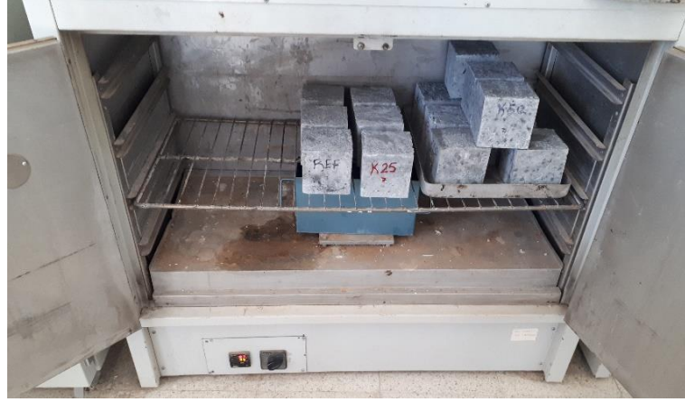
Şekil 2.8. Beton numunelerinin etüvde kurutulması
