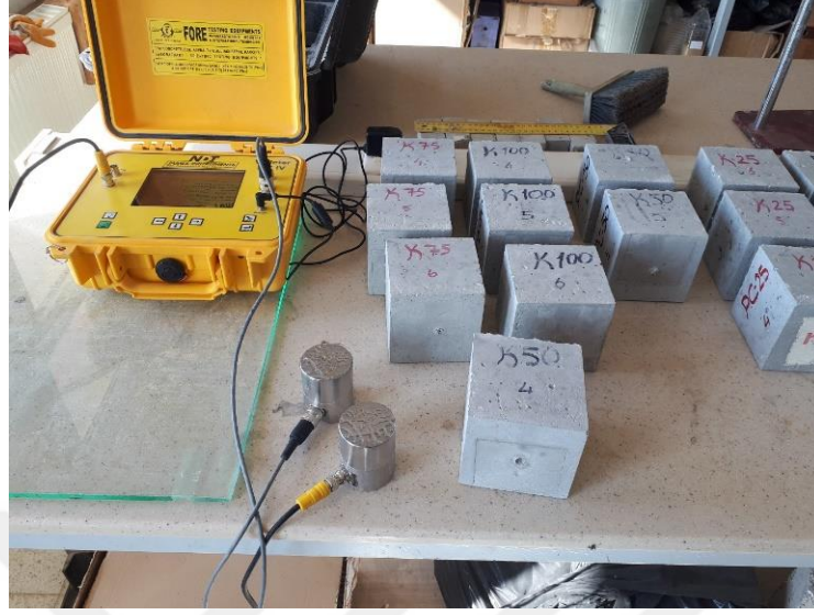
Şekil 2.13. Ultrases geçiş hızı ölçümleri
