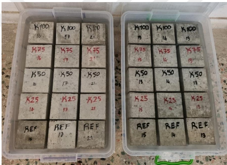
Şekil 2.15. Beton numunelerinin sülfat çözeltilerinde bekletilmesi
