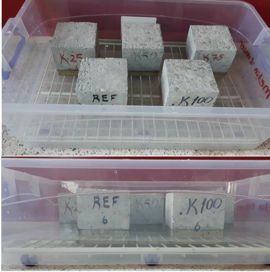
Şekil 2.12. Kılcal su emme deneyinin gerçekleştirilmesi
