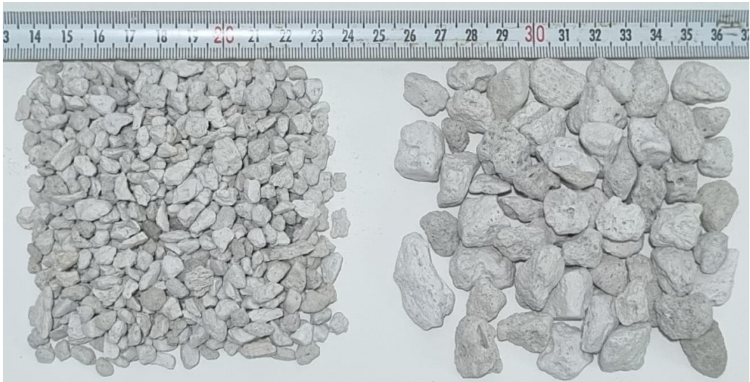
řekil 2.2. Polyester kaplanmamıř pomza agregalari
