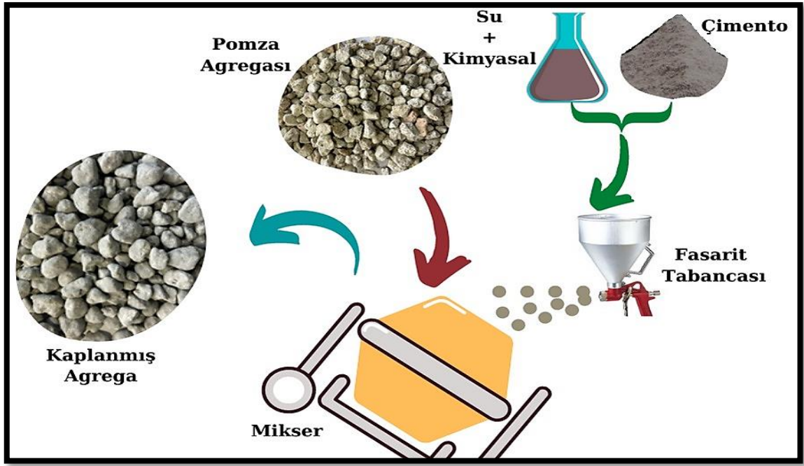
Şekil 3. 6. Pomza agregasının kaplama işlemleri.
