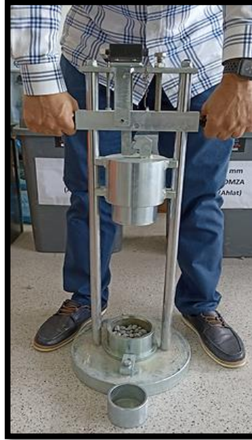
Şekil 3. 12. Agreg darbe katsayısı deneyi.
