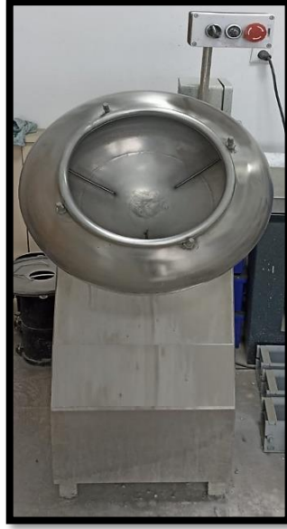
Şekil 3. 2. Kaplama işleminin yapıldığı döner tambur.
