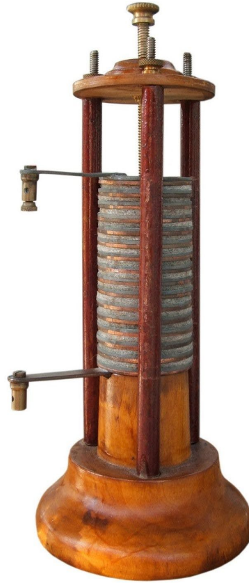
Şekil 1.2. Alessandro Volta'nın İlk Elektrik Hücresi [6].
