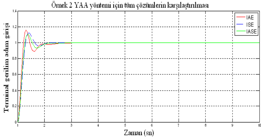
Şekil 4.21: YAA yöntemine ait örnek 2 için terminal gerilim birim basamak (IAE), (ISE), (IASE) değişiminin karşılaştırmalı simülasyon grafiği
