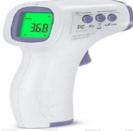
Şekil 3.2. Galena HDT-8813 temassız alından ateş ölçüm cihazı.
