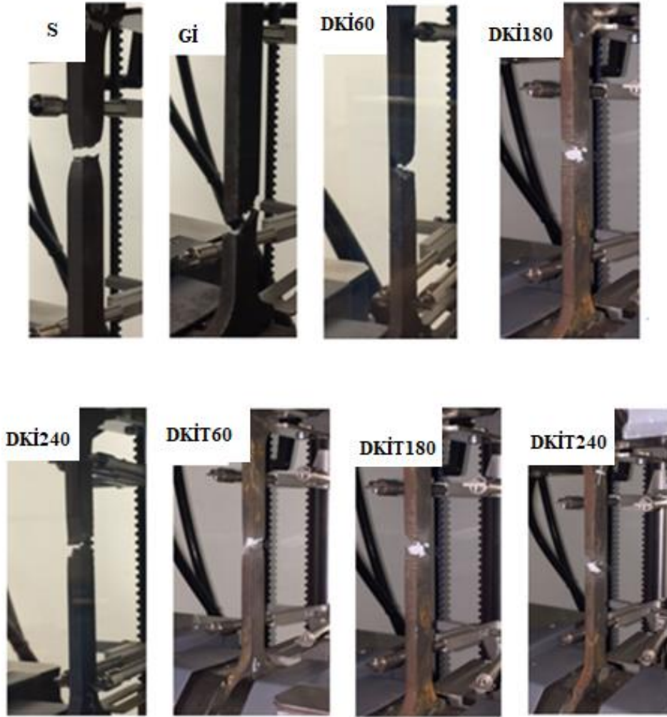
Şekil 6.9. Çekme testi esnasında numunelerin kopma görüntüleri.
