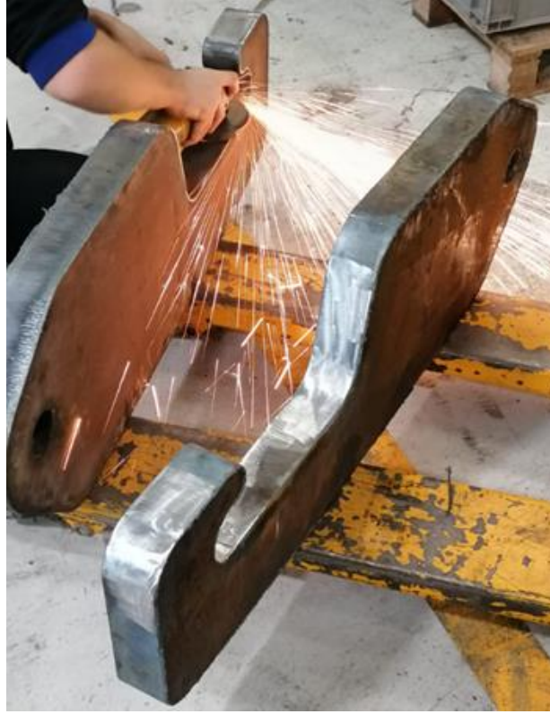
Şekil 4.1. Gerilimölçer sensör uygulanacak bölgelerin temizlenmesi.
