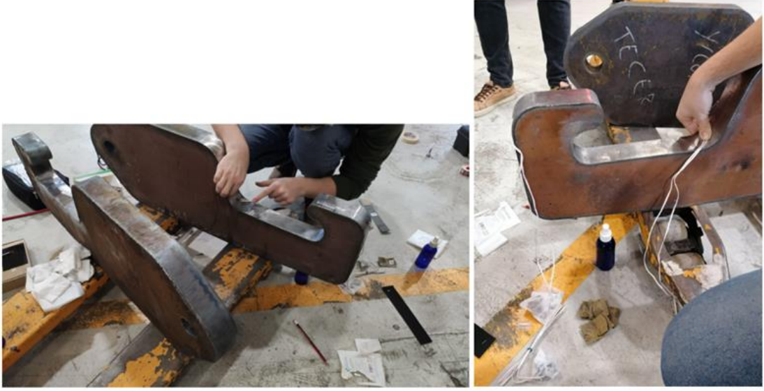
Şekil 4.2. Kancalara gerilimölçer sensörlerinin yapıştırılması.
