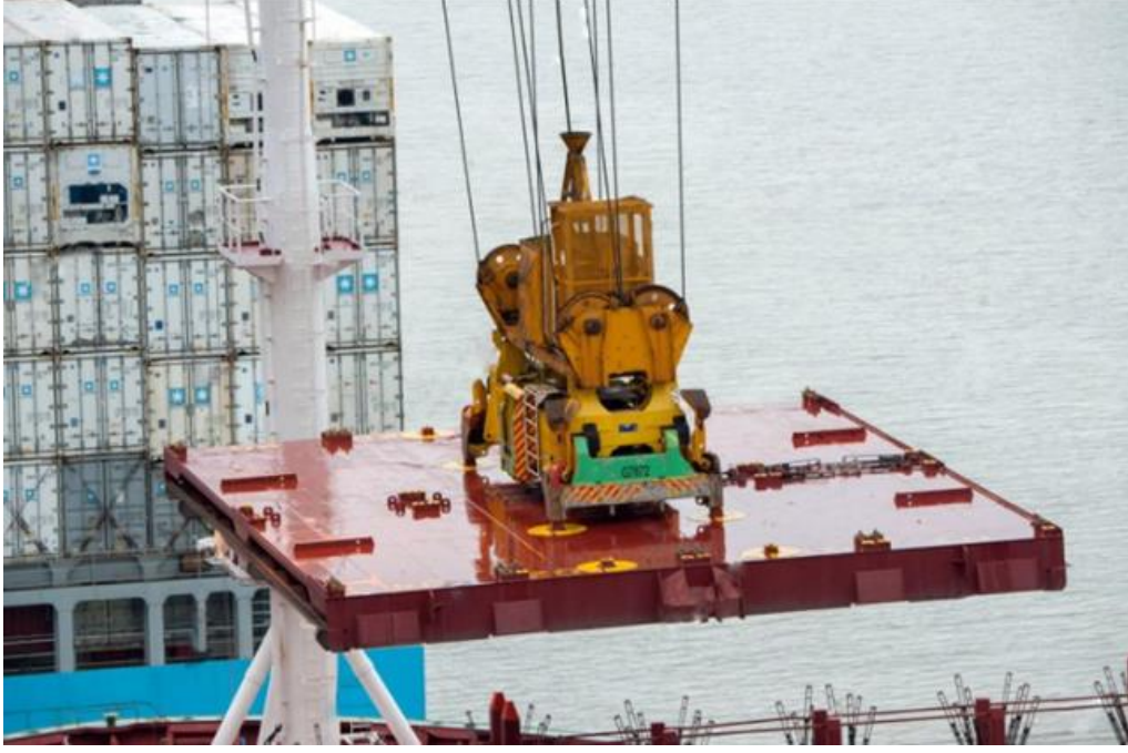
Şekil 1.2. Ponton tipi ambar kapağı [42].
