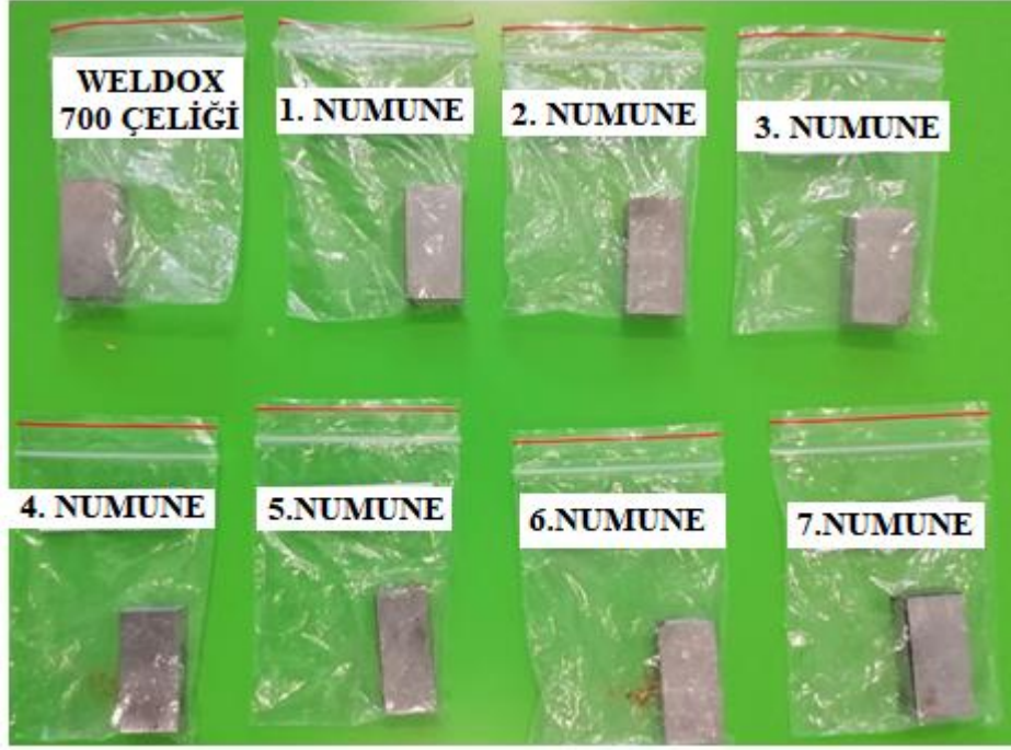
Şekil 5.6. Mikro, makro sertlik ölçme numuneleri.
