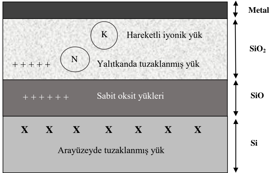
Şekil 2.9. İdeal bir MYY yapısında arayüzey durumları ve yüklerin sınıflandırılması.
