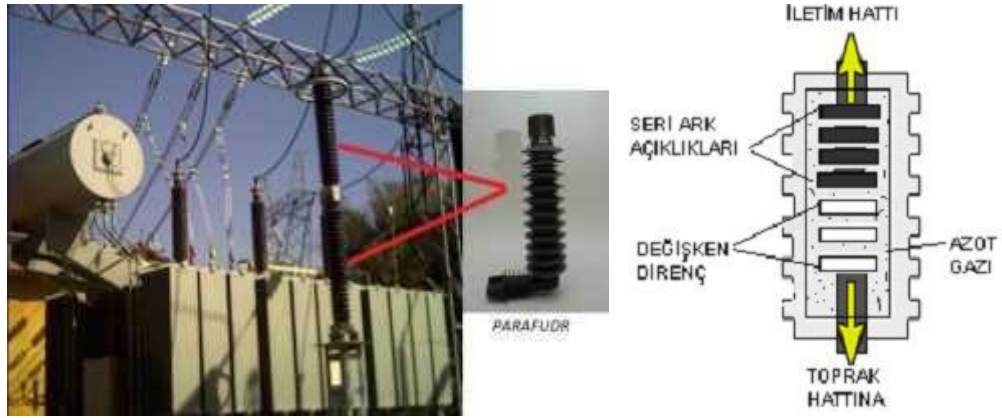
Şekil 2.23. Parafudr Bağlantısı ve İç Yapısı
