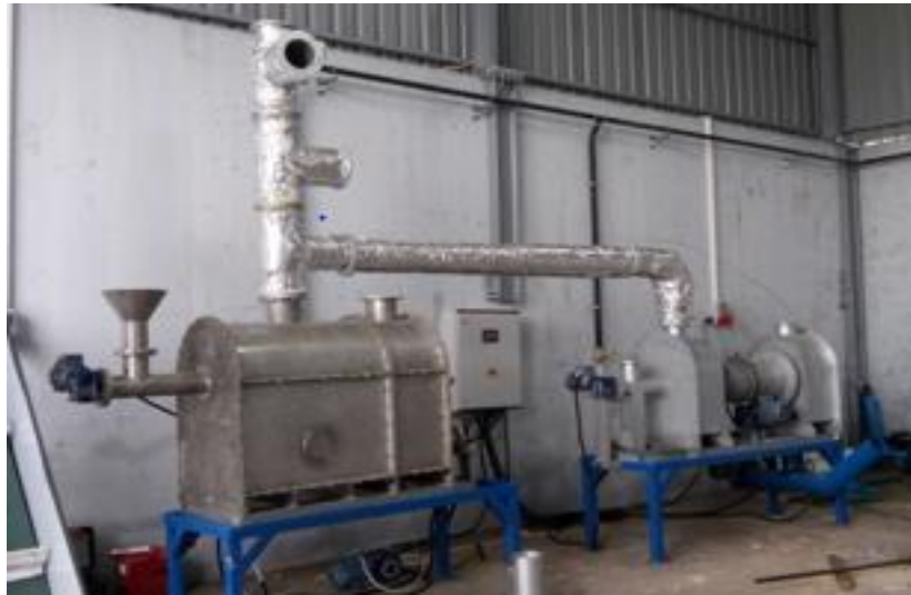
Şekil 2.6. Kurutucu ve piroliz ünitesinin yerleşimi.
