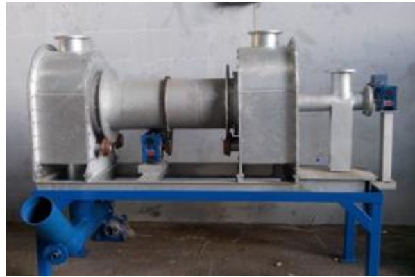
Şekil 2.4. Kurulumu tamamlanan kurutucu ünitesi.
