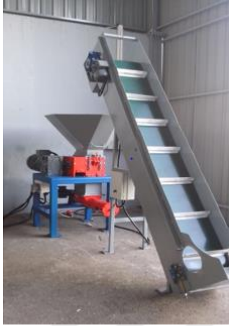
Şekil 2.3. Kırıcı konveyör sistemi.
