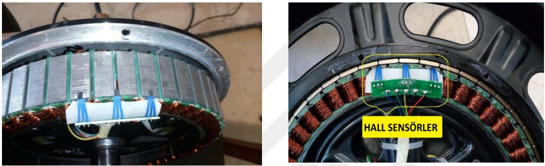
Şekil 3.40. Tekerlek motorda kullanılan Hall sensörler ve stator üzerindeki konumu.
