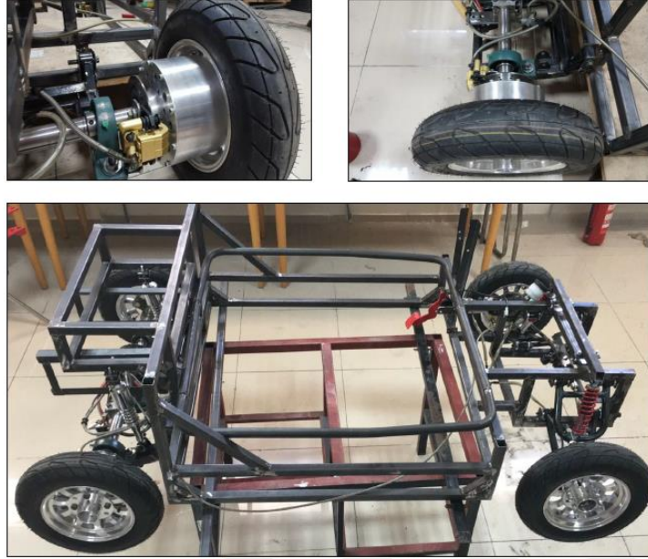
Şekil 3.15. Hub motorlu tasarlanmış bir elektrikli araç şasesi [41].
