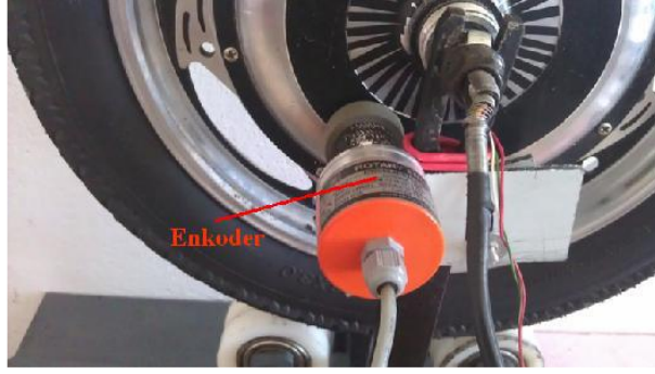
Şekil 3.36. Artımlı bir kodlayıcının tekerlek tipi motora bağlantısı [16].
