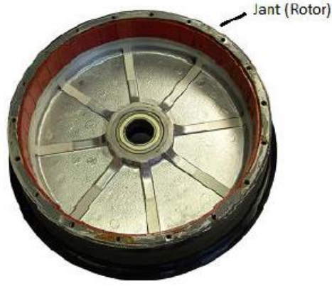
Şekil 3.11. Dış rotorlu FDAM'a ait rotor [17].
