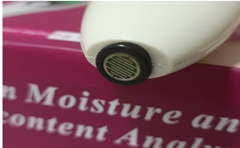
Şekil 2. Moisture oil content analyzer sk-8 cihazı sensörü
