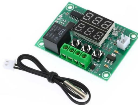
Şekil 3.15. Röle çıkışlı dijital termostat ve ölçüm probu.
