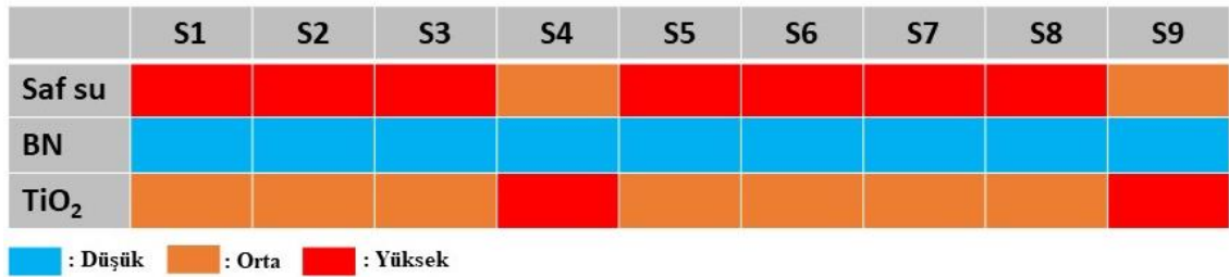
Şekil 4.8. Deşarj deneyi (3C) sonunda sensörlerden alınan sıcaklık verilerinin karşılaştırılması.
