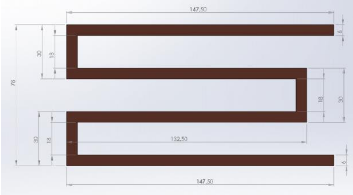
Şekil 3.2. Soğutucu kanalın önden görünüşü.
