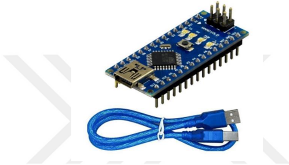
Şekil 3.14. Arduino ve USB bağlantısı.
