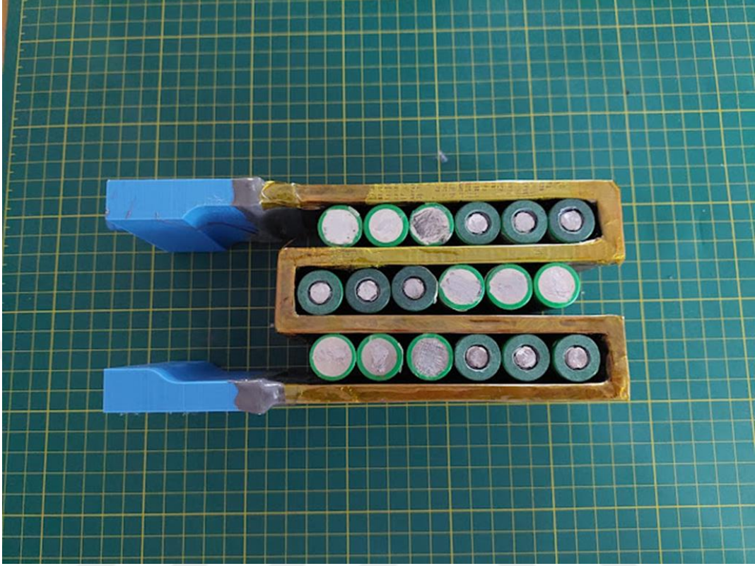
Şekil 3.1. Deneysel çalışmada kullanılan soğutma kanalı ve batarya hücreleri.
