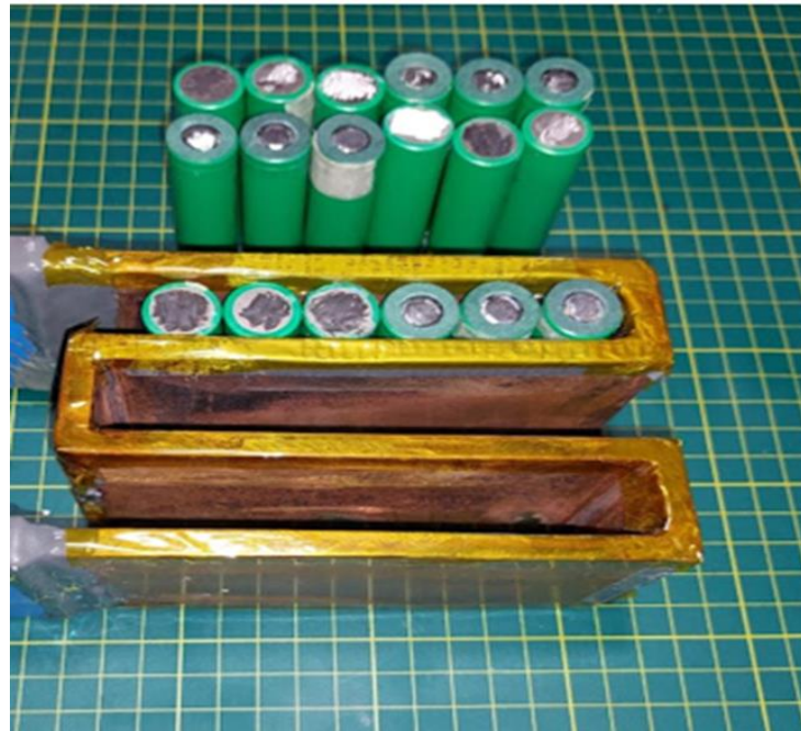
Şekil 3.4. Batarya modülünün oluşturulması için pillerin soğutma kanalına yerleştirilmesi.
