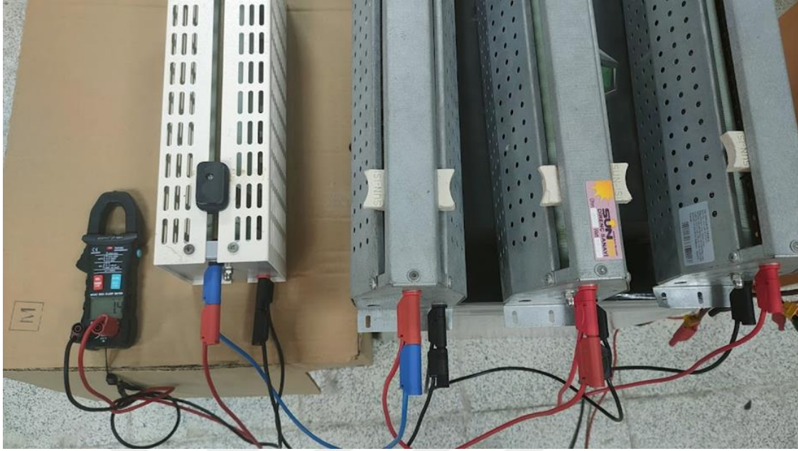
Şekil 3.20. Reostaların birbirine paralel bağlantısı.
