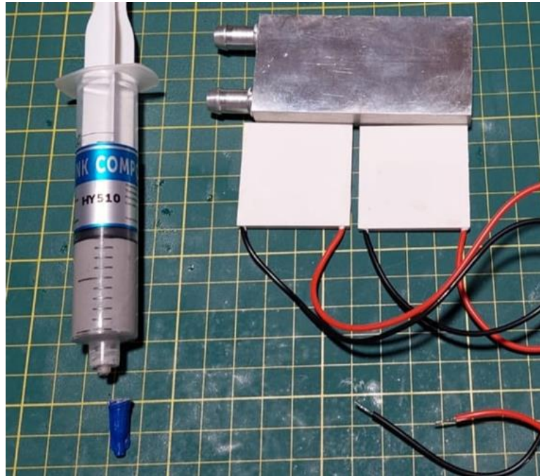
Şekil 3.18. Peltier soğutucunun alüminyum bloğa termal macun ile entegre edilmesi.
