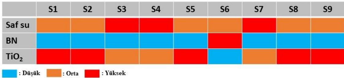
Şekil 4.4. Deşarj deneyi (1C) sonunda sensörlerden alınan sıcaklık verilerinin karşılaştırılması.
