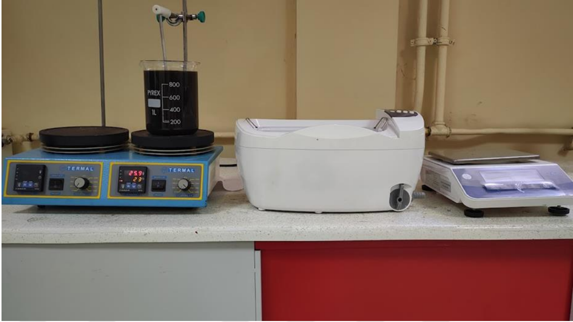
Şekil 3.10. BN-su nanoakışkanın hazırlık süreci boyunca kullanılan cihazlar.
