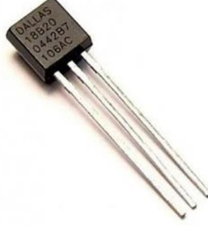
Şekil 3.12. DS18B20 dijital sıcaklık sensörü.
