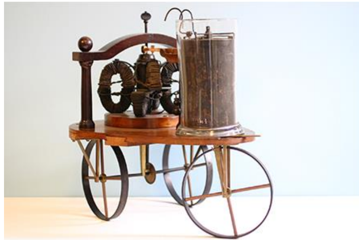
Şekil 1.1. Stratingh tarafından üretilen ilk elektrikli araç [7].
