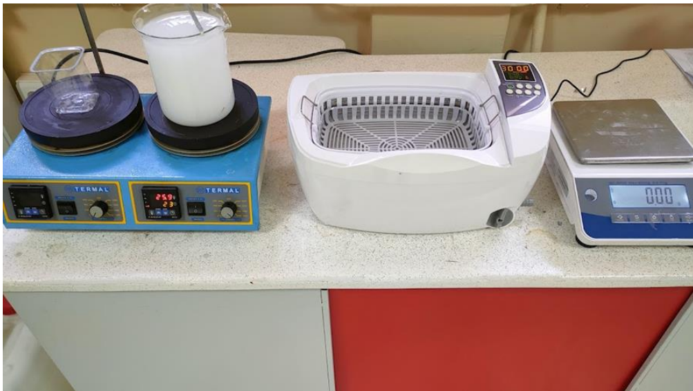
Şekil 3.9. TiO 2 -su nanoakışkanın hazırlık süreci boyunca kullanılan cihazlar.
