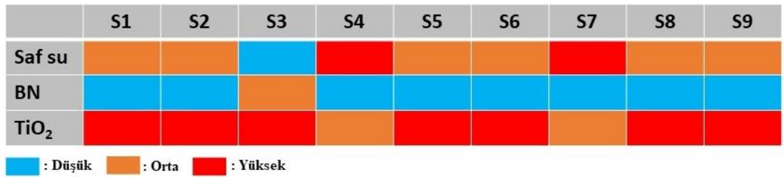
Şekil 4.2. Şarj deneyi (1C) sonunda sensörlerden alınan sıcaklık verilerinin karşılaştırılması.
