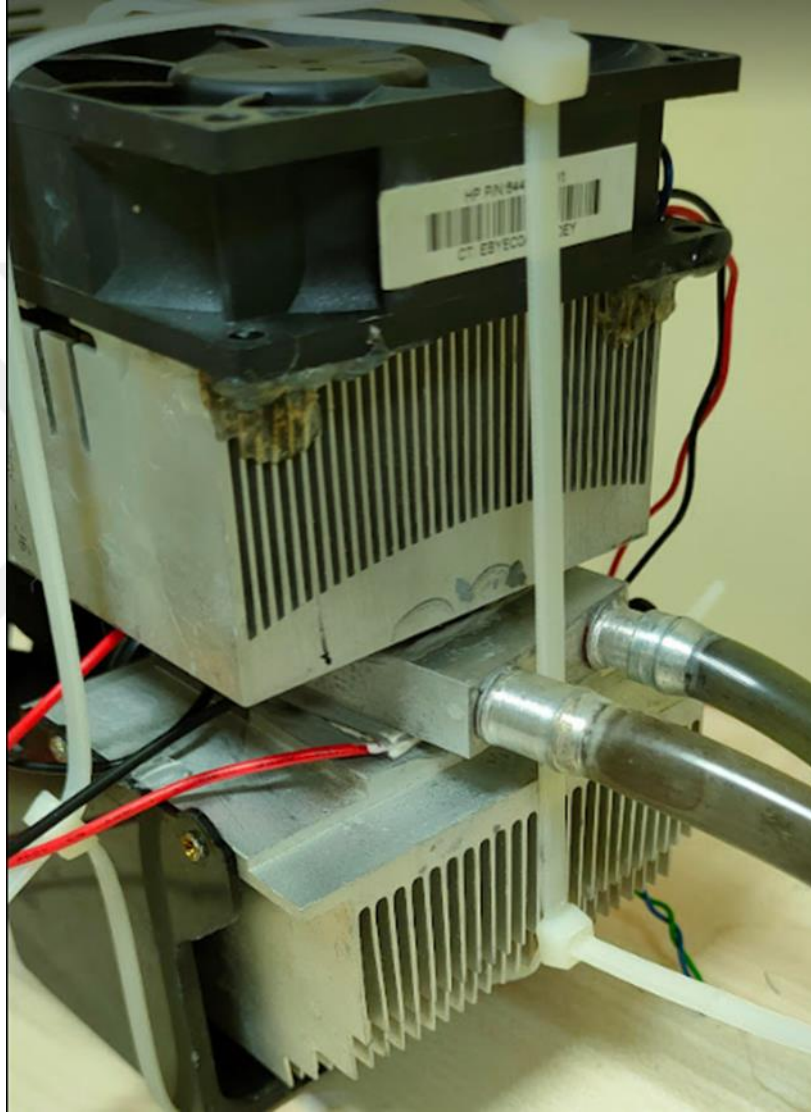
Şekil 3.16. Termoelektrik peltier soğutma sistemi.
