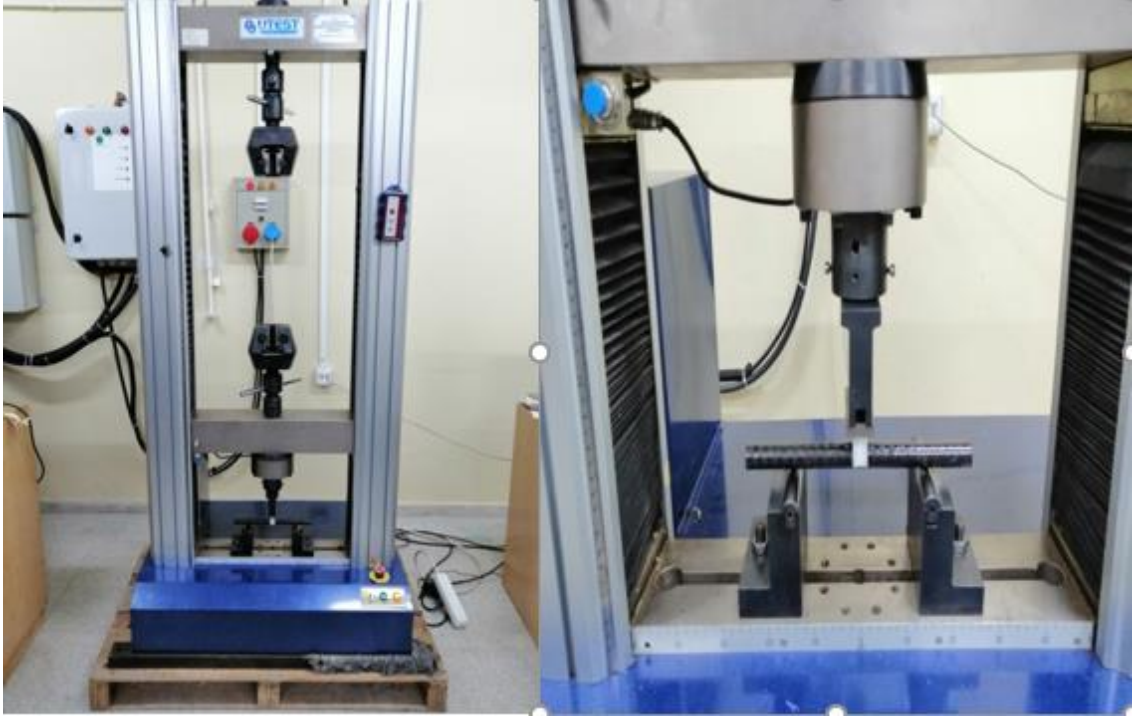
Şekil 4.4. Üç nokta eğilme test düzeneği.
