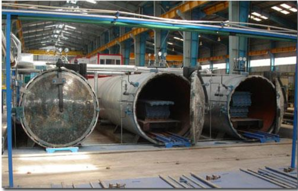
Şekil 3.11. Sanayi tipi otoklav fırınları [81].
