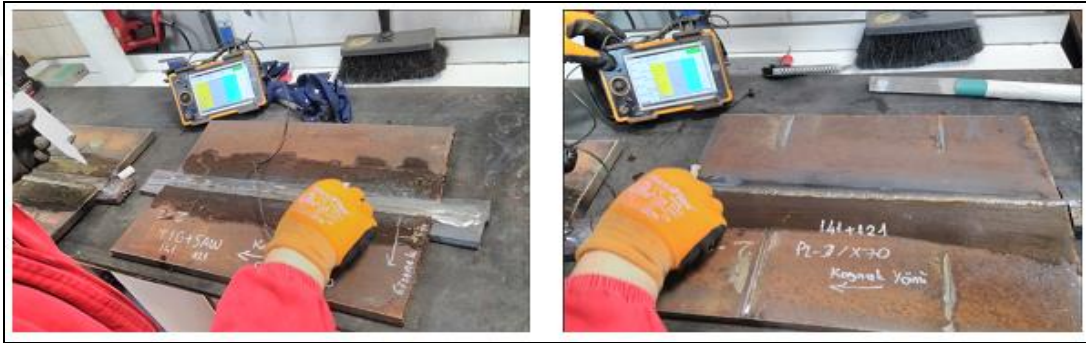
Şekil 6.5. Dijital radyografi muayene görüntüleri a) 16,87 PL-5 görünümü b) 16,87 mm PL-4 görünümü.
