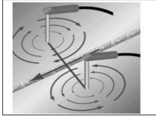
Şekil 5.10. Parça içinden akım geçirerek manyetikleştirme [32].
