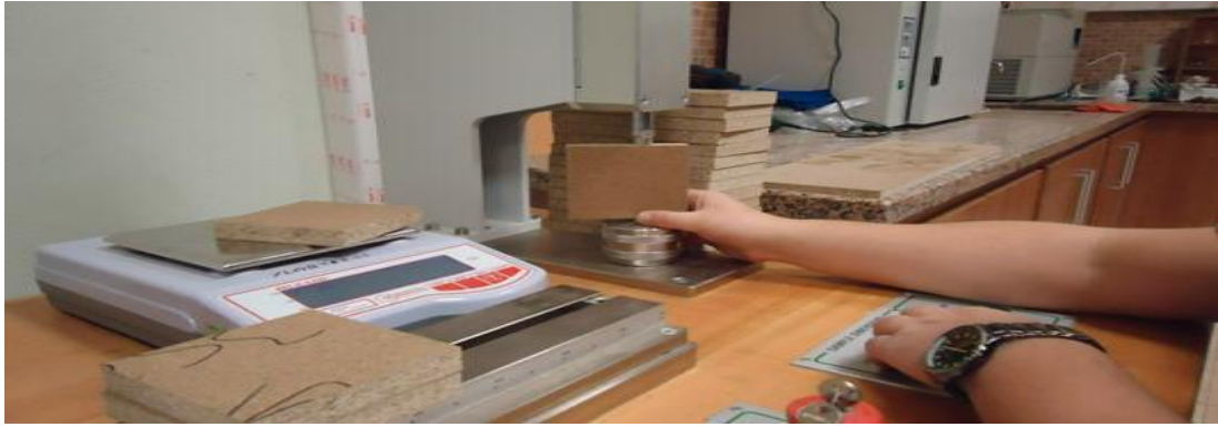
Şekil 1.16. Yoğunluk deneyinde örnek boyutlarının ölçümü.
