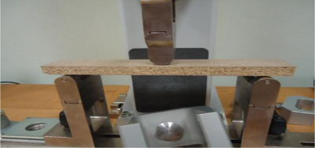
Şekil 1.19. Test levhalarına ait eğilme direnci ve eğilmede elastikiyet modülü deneyi.
