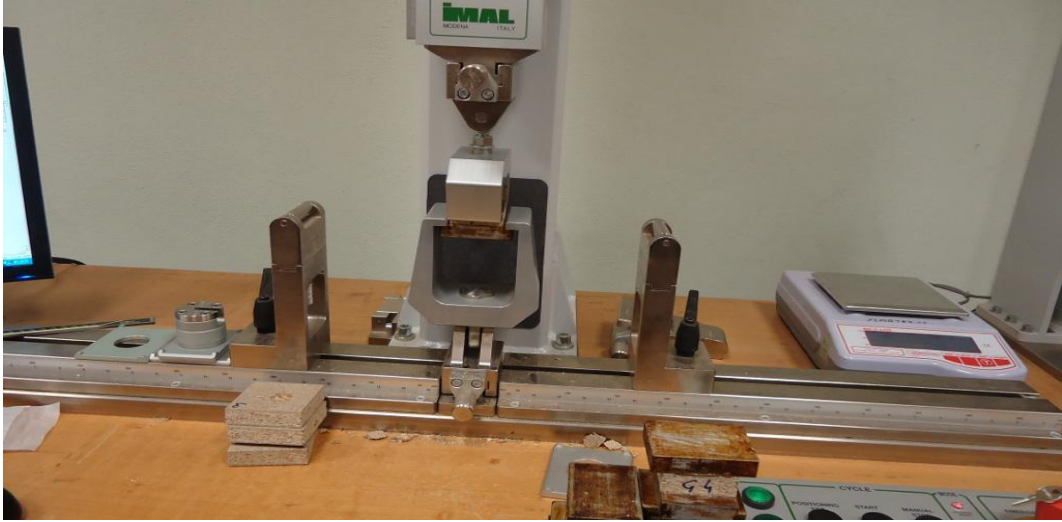
Şekil 1.20. Yongalevhaların yüzeye dik çekme direnci deney görüntüsü.
