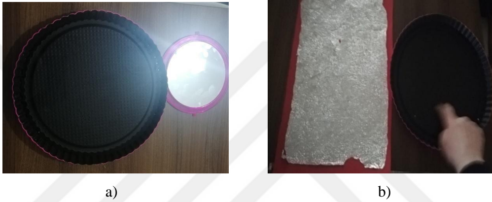
Şekil 4.18. Nur’un düzgün yansımaya ve dağınık yansımaya yapan yüzeyleri sınıflandırması a) Düzgün yansımaya yapan yüzeyler b) Dağınık yansımaya yapan yüzeyler.
