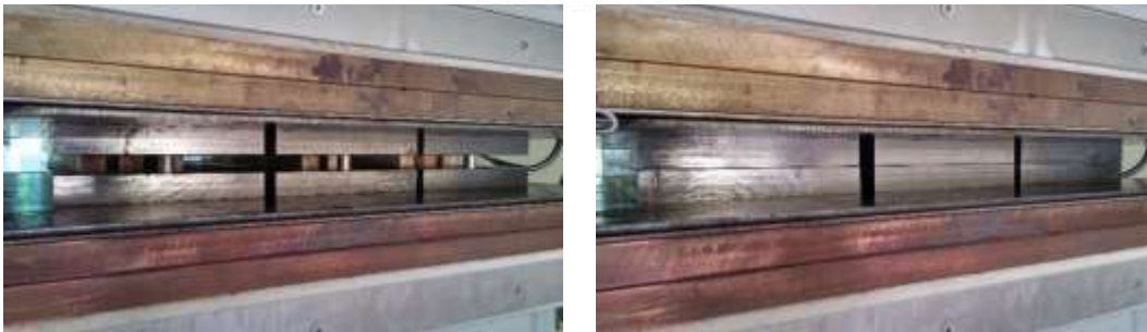
Görsel 1. Deney numunelerinin metal kalıplar yardımı ile yoğunlaştırılması
