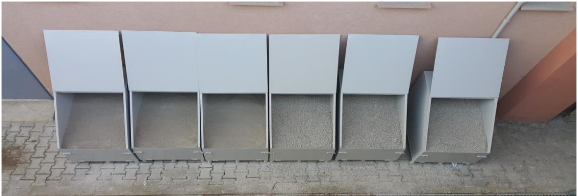
Şekil 5.2. Agregaların muhafaza haznelerine yerleştirilmesi.
