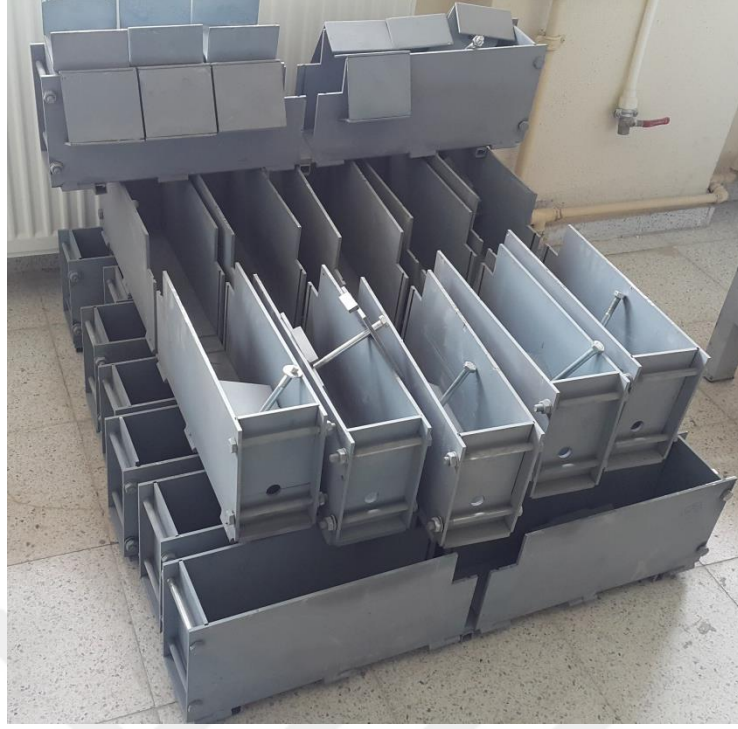
Şekil 5.5. Mafsallı kirişlerin üretimi için yaptırılan özel kalıplar.
