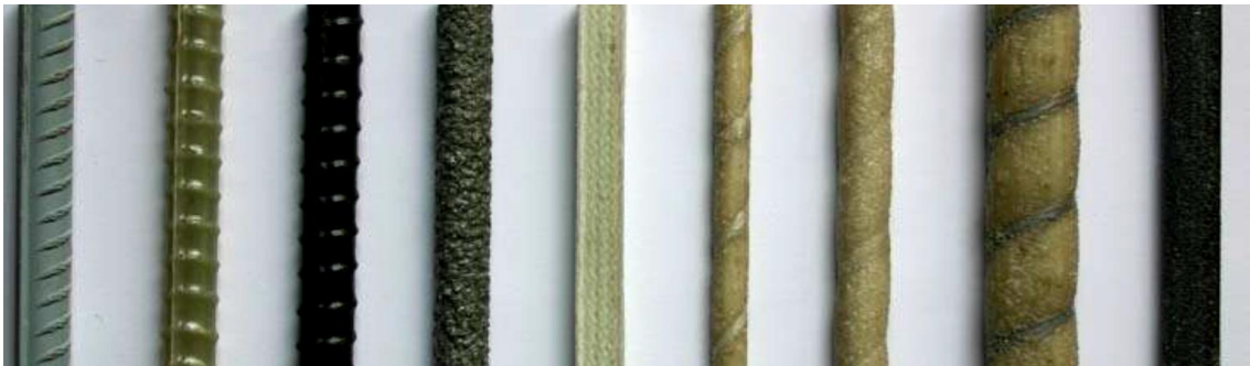
Şekil 2.9. Pultruziyon yöntemi ile üretilmiş bazı donatı çubukları [25].
