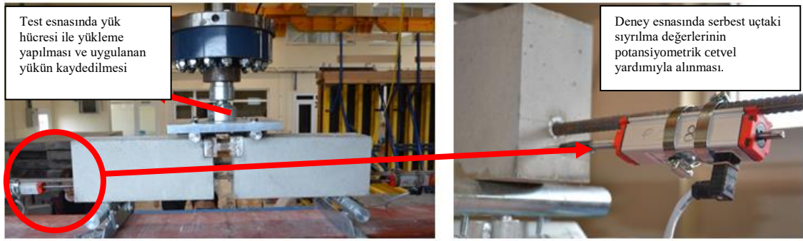
Şekil 5.15. Mafsallı kiriş deney düzeneği.
