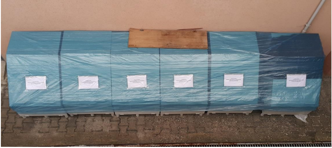
Şekil 5.3. Atmosferik koşullara karşı agregaların koruma altına alınması.
