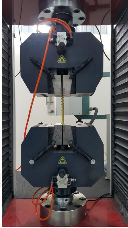
Şekil 5.10. Kompozit donatılarda çekme deneyinin uygulanışı.
