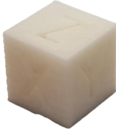
Şekil 5.8. FDM 1 NO 300 µm ABS yüzey pürüzlülüğü deneyi numunesi görüntüsü.
