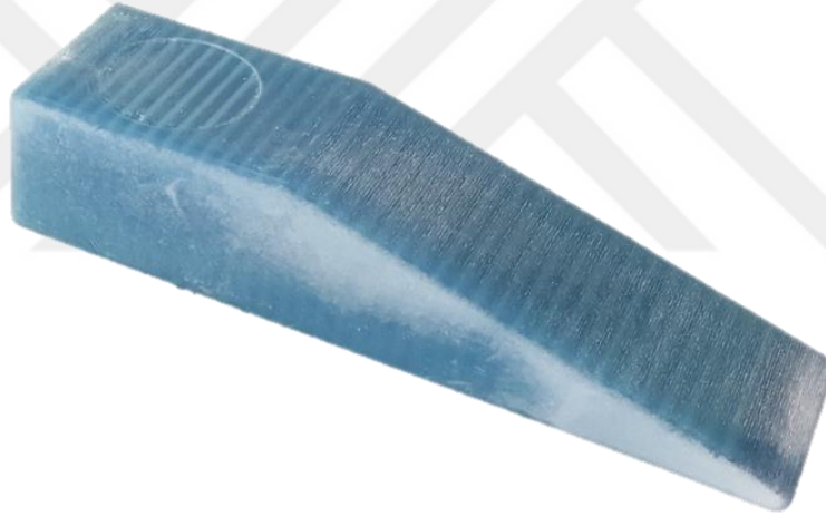
Şekil 5.37. 2 NO %80 destek kayıpları deneyi numunesi görüntüsü.
