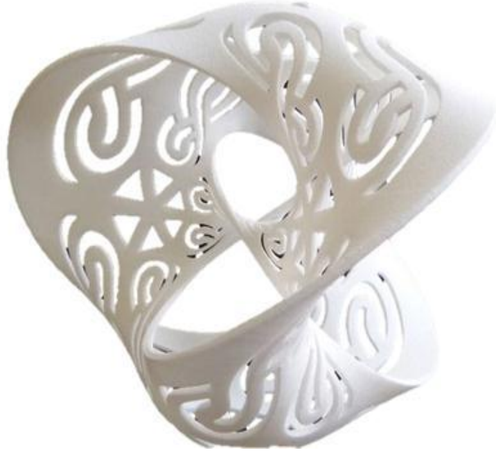
Şekil 3.2. Çok boyutlu yazıcı harici tek parça üretimi imkansız model [48].
