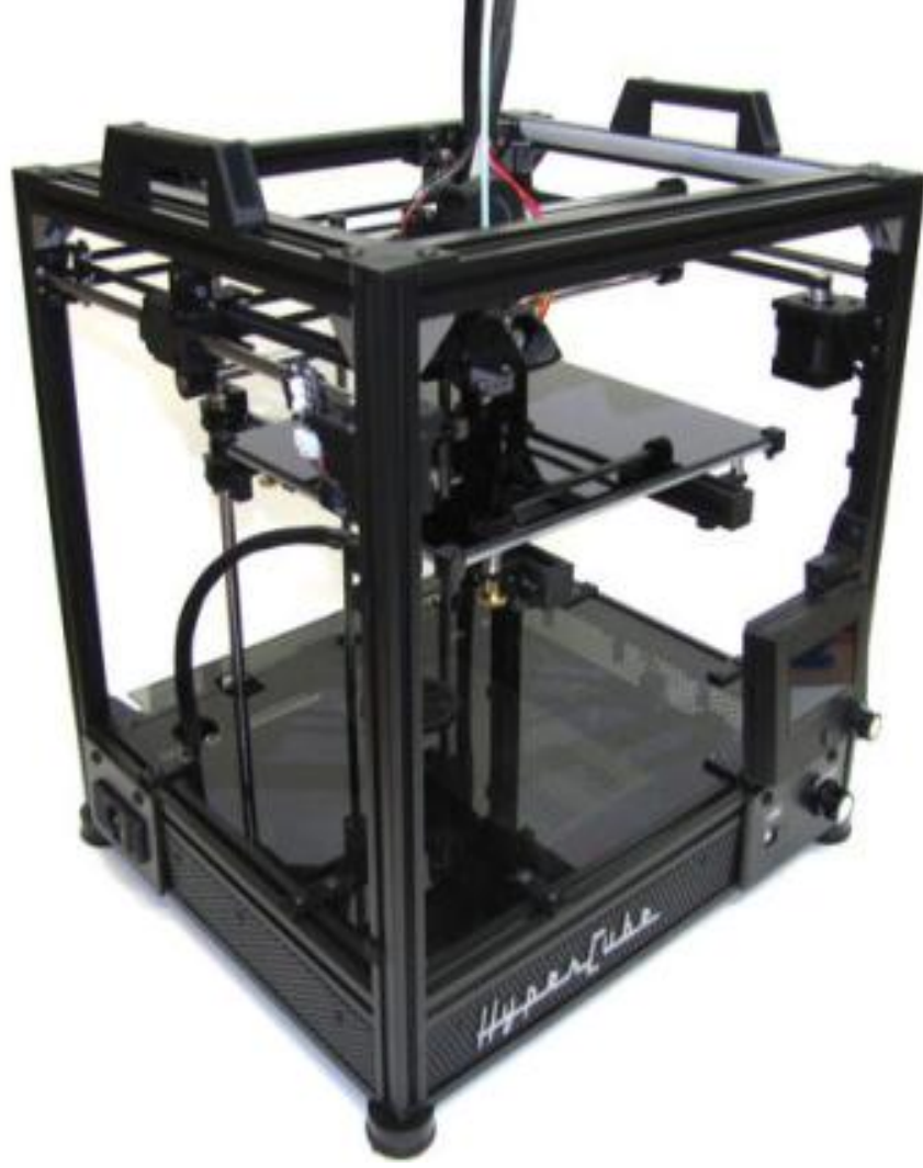
Şekil 3.6. Corexy tipi FDM çok boyutlu yazıcı örneği [56].
