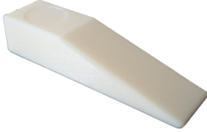
Şekil 5.31. FDM 1 NO ABS %80 destek kayıpları deneyi numunesi görüntüsü.
