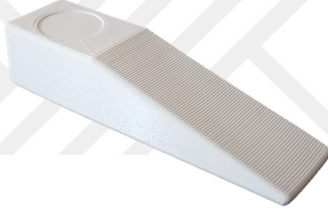
Şekil 5.32. FDM 1 NO PLA %20 destek kayıpları deneyi numunesi görüntüsü.
