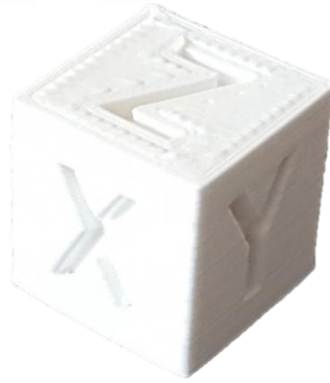
Şekil 5.16. FDM 1 NO 300 µm PLA yüzey pürüzlülüğü deneyi numunesi görüntüsü.
