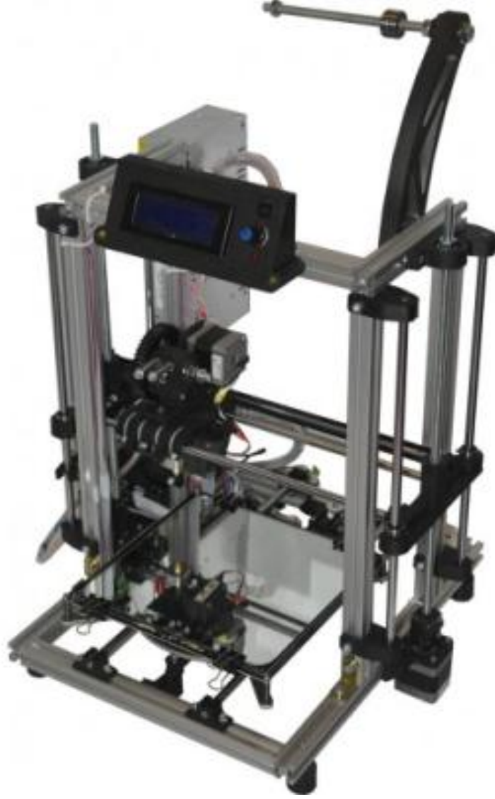
Şekil 3.5. Kartezyen tipi FDM çok boyutlu yazıcı örneği [55].
