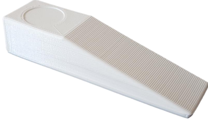
Şekil 5.34. FDM 1 NO PLA %80 destek kayıpları deneyi numunesi görüntüsü.
