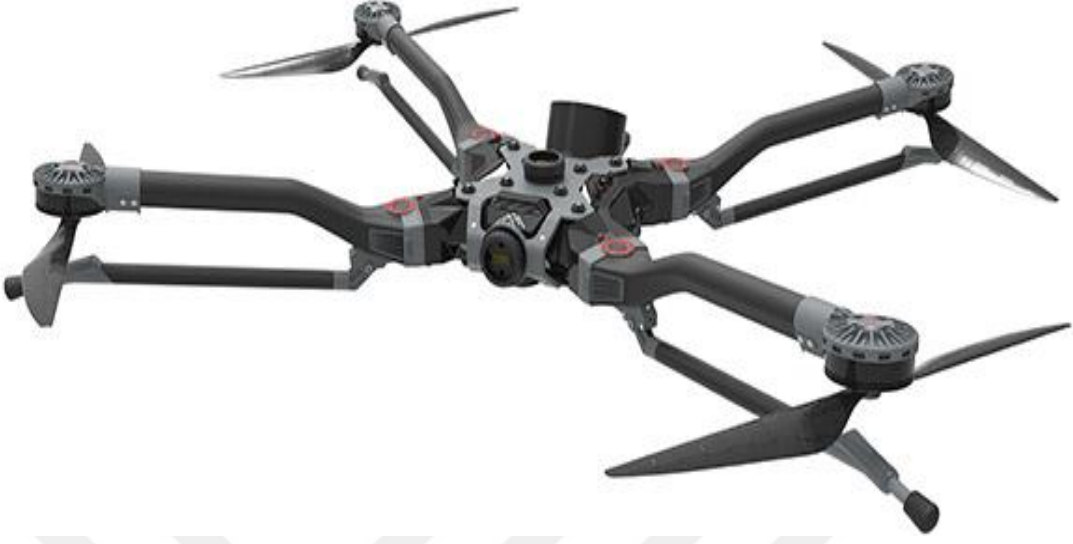
Şekil 3.21. Çok boyutlu yazdırma teknolojisi ile üretilmiş drone örneđi [92].
