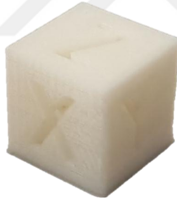
Şekil 5.4. FDM 1 NO 200 µm ABS yüzey pürüzlülüğü deneyi numunesi görüntüsü.
