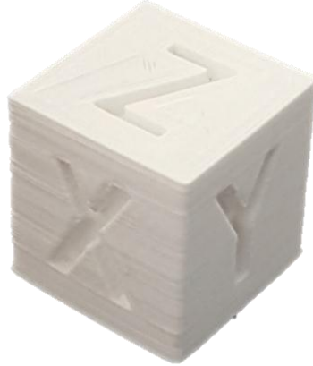
Şekil 5.12. FDM 1 NO 200 µm PLA yüzey pürüzlülüğü deneyi numunesi görüntüsü.
