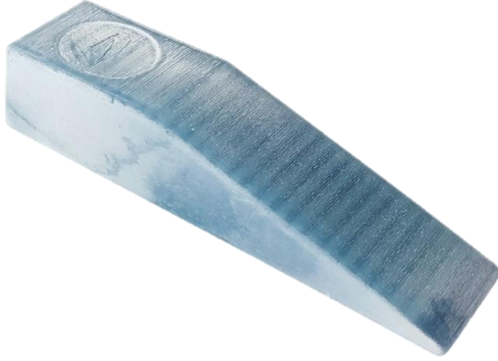
Şekil 5.36. 2 NO %50 destek kayıpları deneyi numunesi görüntüsü.
