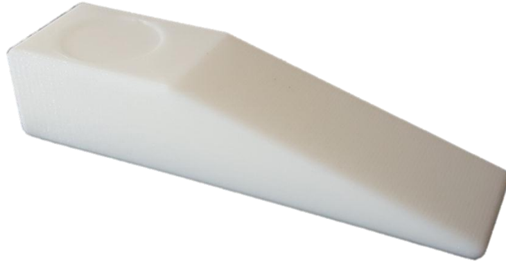
Şekil 5.30. FDM 1 NO ABS %50 destek kayıpları deneyi numunesi görüntüsü.
