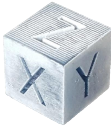
Şekil 5.24. 2 NO 32 µm yüzey pürüzlülüğü deneyi numunesi görüntüsü.
