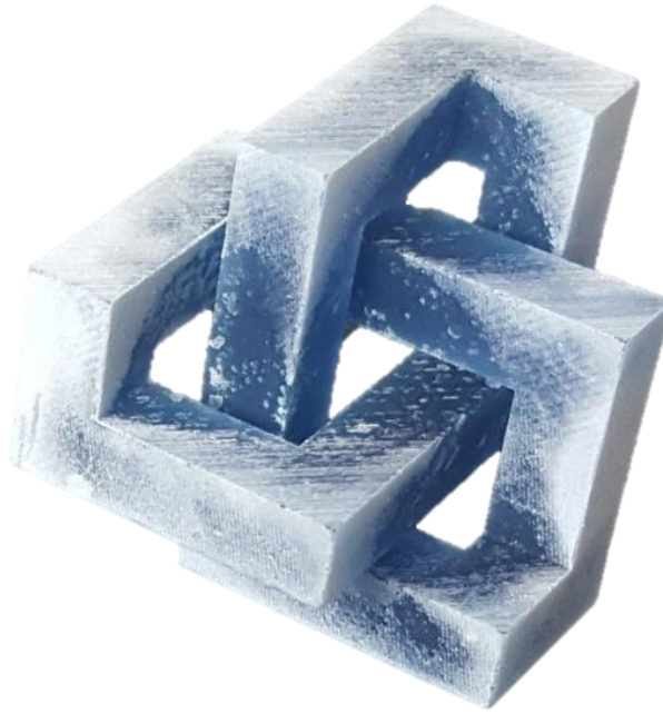
Şekil 5.43. 2 NO kapalı geçme deneyi numunesi görüntüsü.
