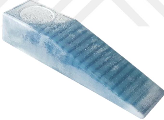
Şekil 5.35. 2 NO %20 destek kayıpları deneyi numunesi görüntüsü.
