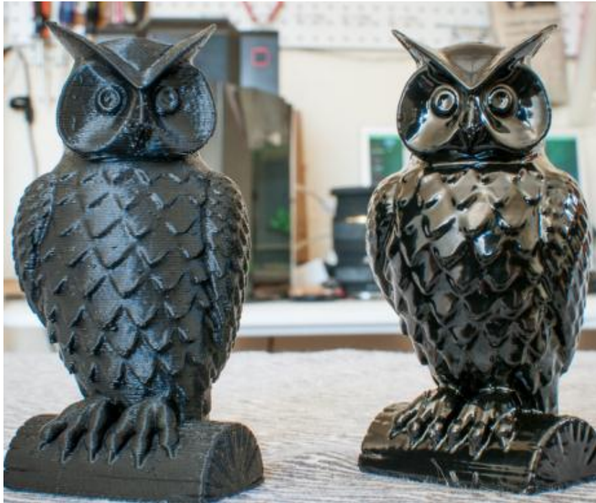
Şekil 3.16. Son işlem örneği (Aseton banyosu) [80].
