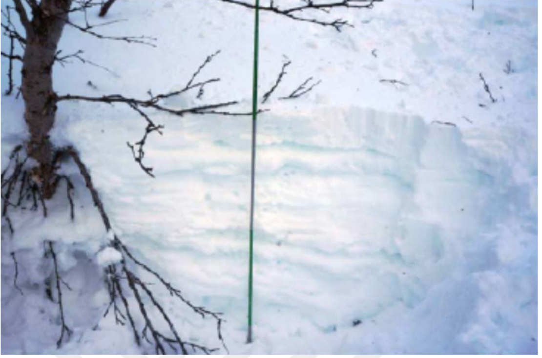
Şekil 3.2. Kar örtüsü içerisinde gövdesi ve dallarıyla bir ankraj görevi gören kayın ağacı [39].
