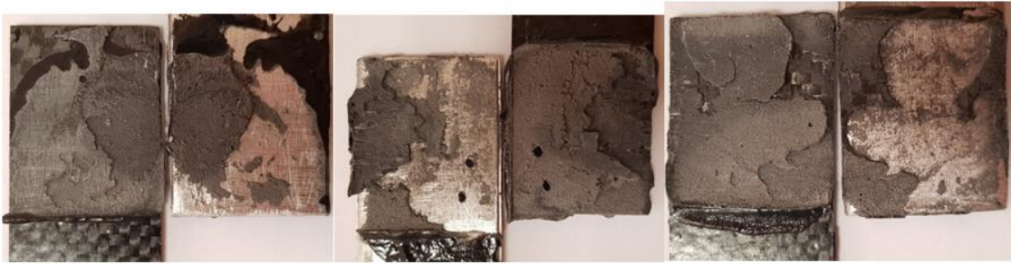
Şekil 4.6. PT326 yapıştırıcı için oda sıcaklığında kopma yüzeyi. a Kompozit-kompozit b.Kompozit-alüminyum
