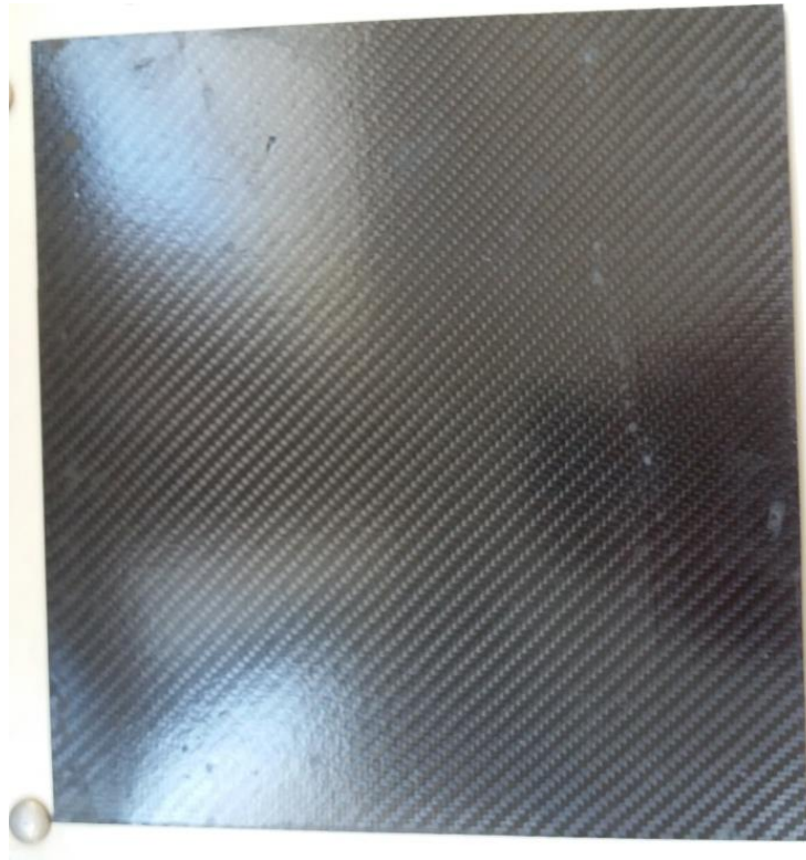
Őekil 3.1. Sıcak pres tezgahında retilen kompozit paralar .
