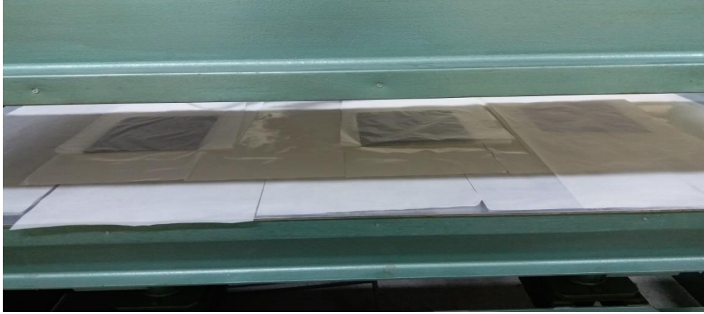
Őekil 3.1. Sıcak pres tezgahında retilen kompozit paralar .
