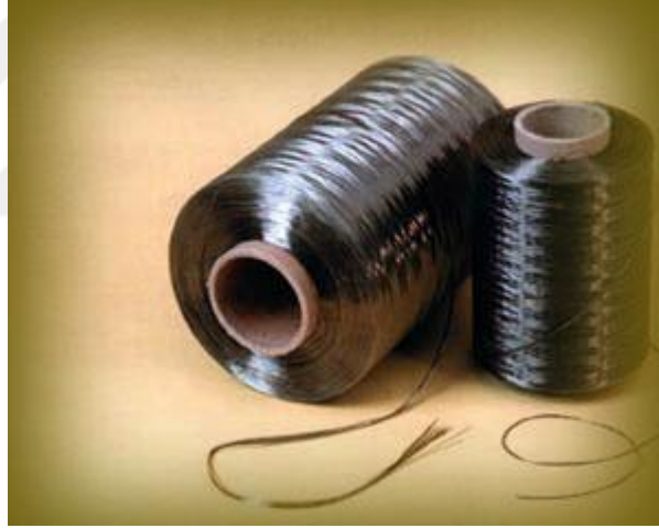
Şekil 2.7. Sürekli sarma yöntemi ile üretilen bazalt lif [29].
