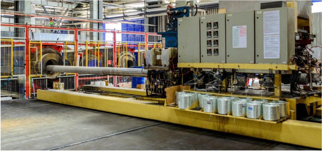
Şekil 2.11. Savurma döküm üretim hattı [44].
