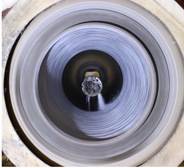
Şekil 2.10. Savurma döküm metodu besleme sistemi [4].
