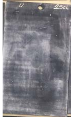
Şekil 3.12. EPDM plakası-12'nin bekleme sonrası yüzey görünümü.
