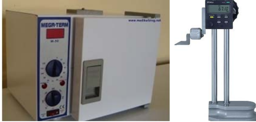
Şekil 2.7. Kalıcı deformasyon testi için etüv ve mihengir.
