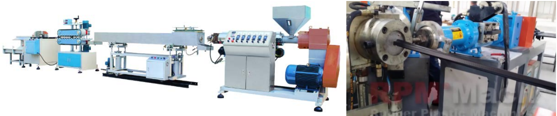
Şekil 1.10. Tipik bir ekstrüzyon hattı ve sızdırmazlık profili üretimi.
