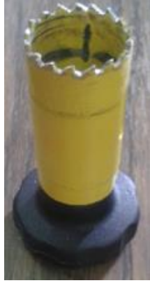
Şekil 4. Tutkalin kurumasından sonra çekme silindirisinin çevresinde oluşan tutkalin alınması için kullanılan kesici deney aleti (Cutting test tool used to remove glue formed around the drawing roller after drying the glue).
