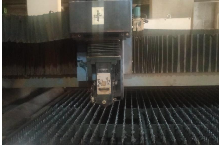
Şekil 4.2. CNC lazer kesim makinesi kesici lazeri.
