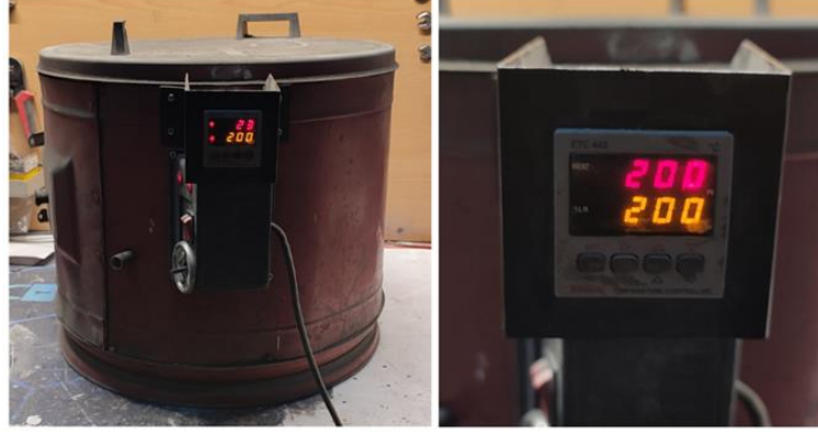
Şekil 4.6. Isı yalıtım testinde kullanılan kutu fırın.
