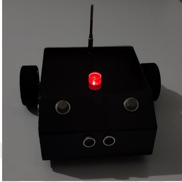
Şekil 5.17. Metan birikimi tespit edildiğinde robotun görünümü.
