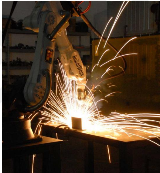
Şekil 3.6. Endüstriyel kaynak robotu [44].
