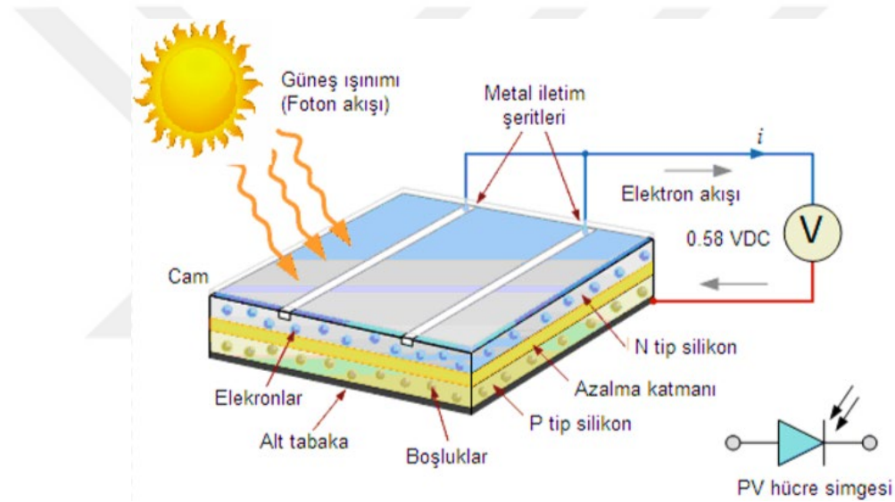
Şekil 2.1. FV hücrelerinin çalışma prensibi [13].
