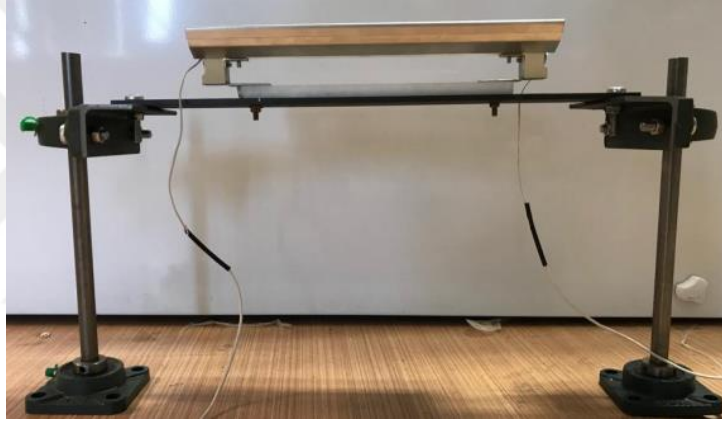
Şekil 3.6. Yüksekliği ayarlanabilir kızılötesi lamba tutucu.
