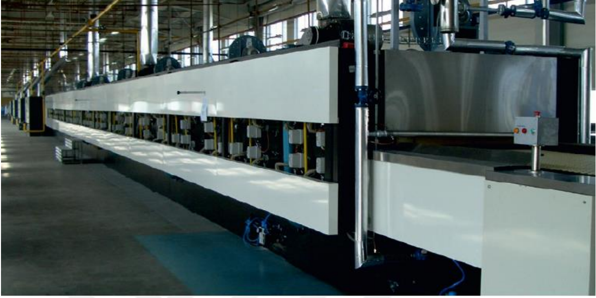
Şekil 2.11. Konvansiyonel/Radyant hibrit bisküvi fırını [46].
