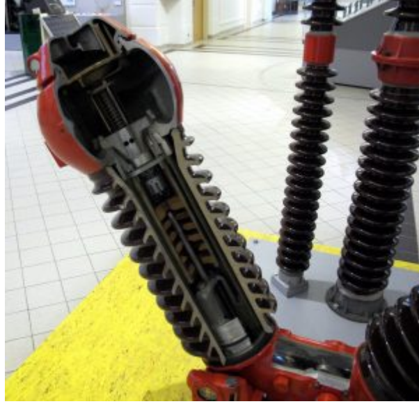
Şekil 3.4. Az yağlı kesici kontak görünüş [24].
