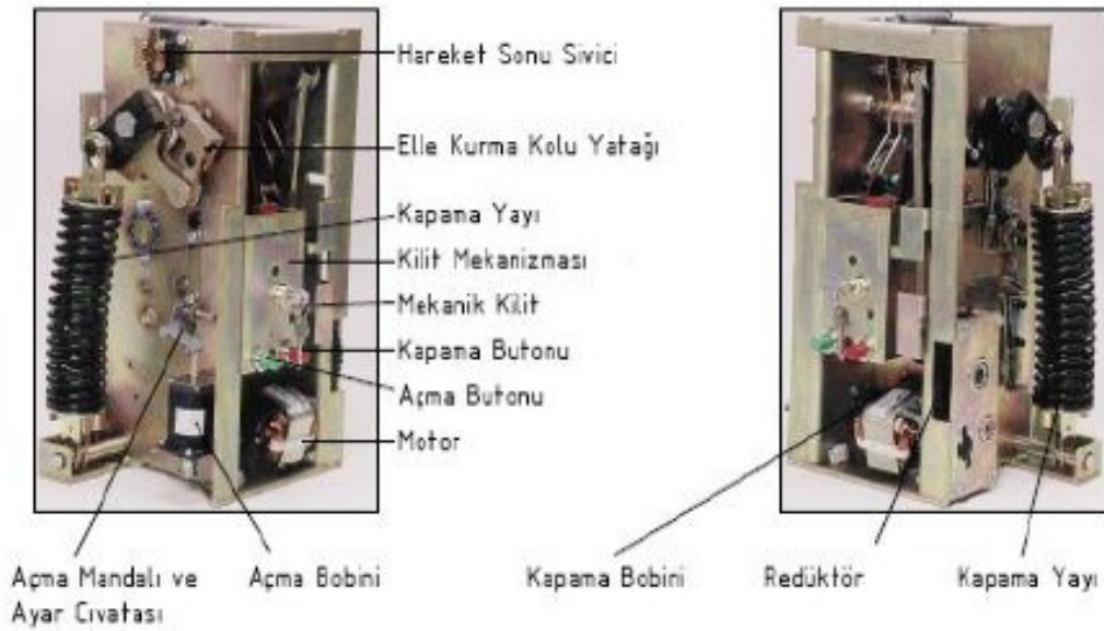
Şekil 2.7. Orta gerilim kesici mekanizması [26].
