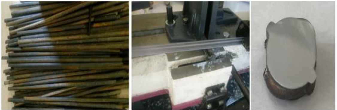
Şekil 2.2. Korozyon deneylerinde kullanılan nervürlü betonarme çeliği.
