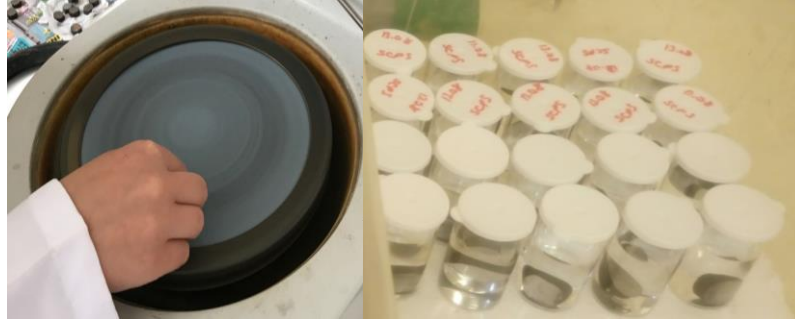
Şekil 2.3. Metallerin zımparalanması ve numune kaplarına yerleştirilmesi.
