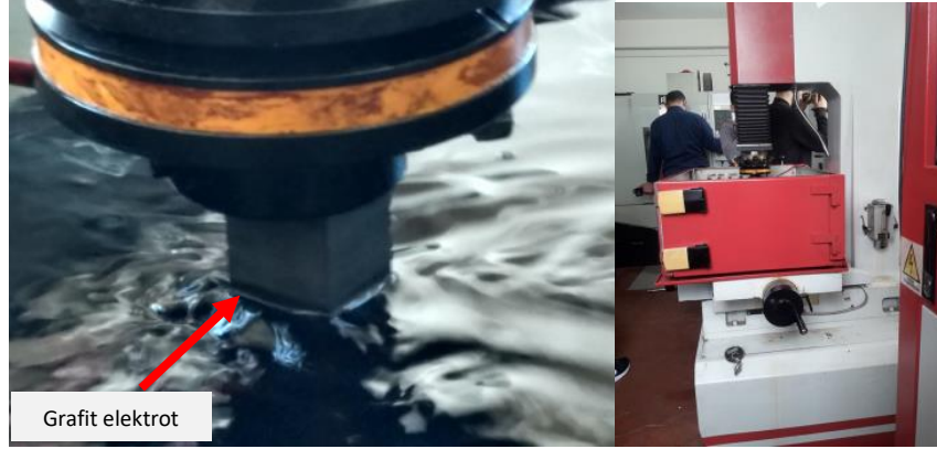
Şekil 4. Dalma erozyon tezgâhında işleme fotoğrafları
