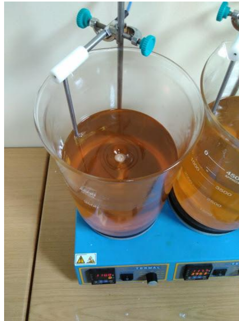
Şekil 5.16. Biyodizel içerisinde kalan suyun buharlaştırılması.
