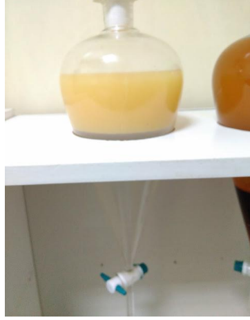
Şekil 5.15. Biyodizel yakıtının yıkanması ve Ph'nın ayarlanması.
