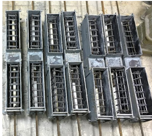
Şekil 2.2. Mafsallı kirişlerin üretiminde kullanılan modüler çelik kalıplar.
