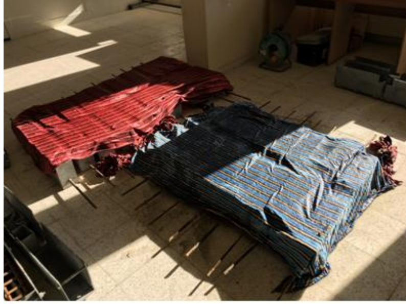
Şekil 2.5. Mafsallı kiriş deney numunelerine kür uygulaması.
