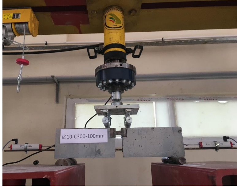
Şekil 2.6. Mafsallı kiriş deneyinde bir görünüm.
