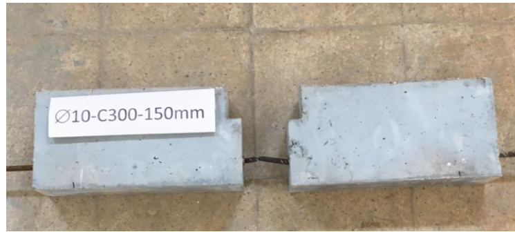
Şekil 3.5. Donatının koptuğu kiriş numunesi.
