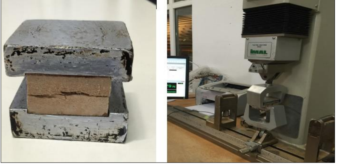
Şekil 2.6. Levha yüzeyine dik çekme dayanımı tayini için deney makinası düzeneği [76].
