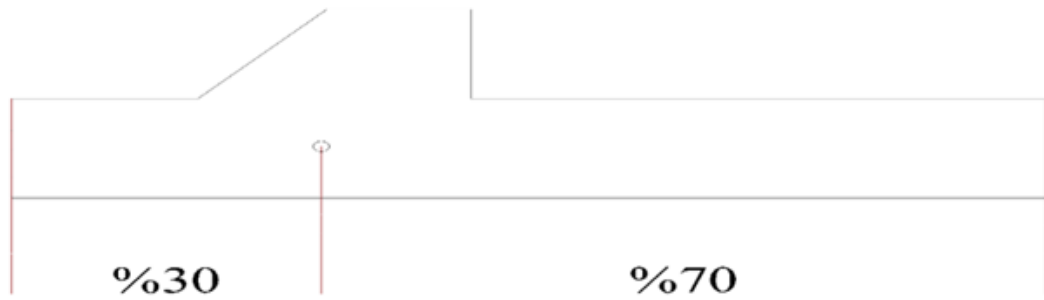
Şekil 3.2. Traktörün ağırlık merkezinin yatay ekseninde belirlenmesi.
