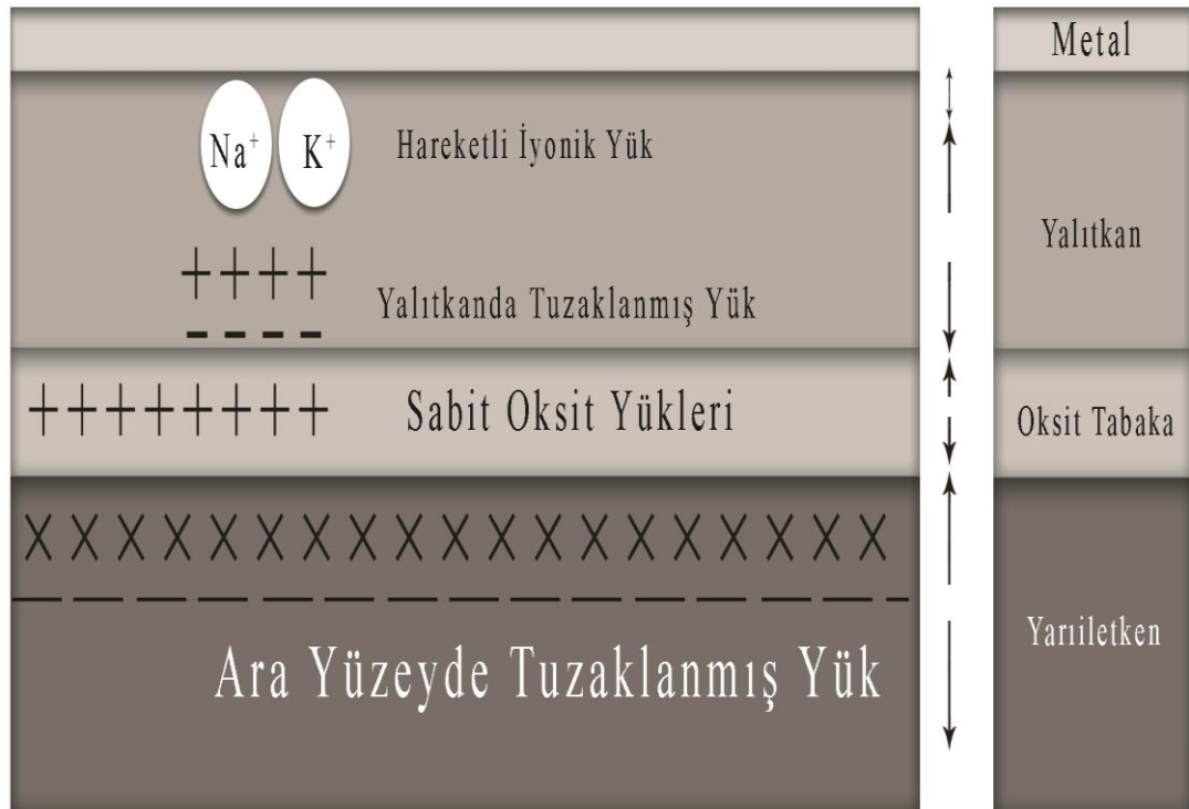
Şekil 2.8. İdeal olmayan MIS yapıda arayüzey durumları ve yüklerin sınıflandırılması.
