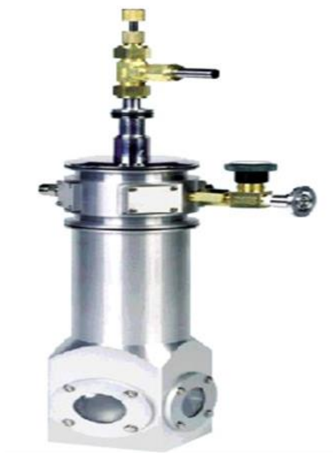
Resim 4.2. Lake Shore model 321 sıcaklık kontrol sistemi, Janis vpf-475 kriyostat.
