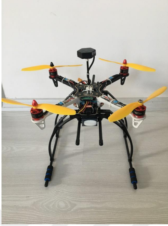
Şekil 5.21. WiFi çoğaltıcı entegreli drone.
