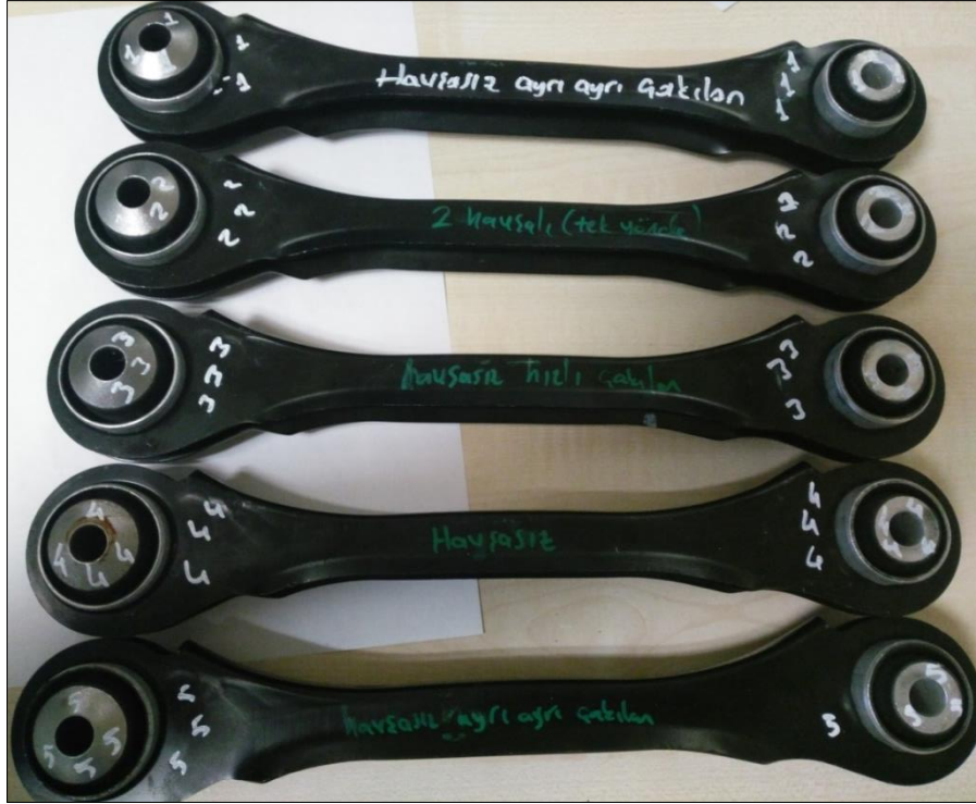
Şekil 4.8. Kumlama işlemi yapılmış ve salıncaklara çakılmış burçlar (B_02).
