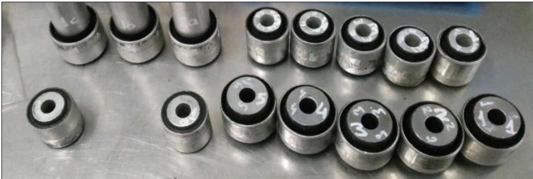
Şekil 4.13. Çıkma testinden sonra çıkan burçların yüzey pürüzlerinin ezilmesiyle parlayan görünümleri.
