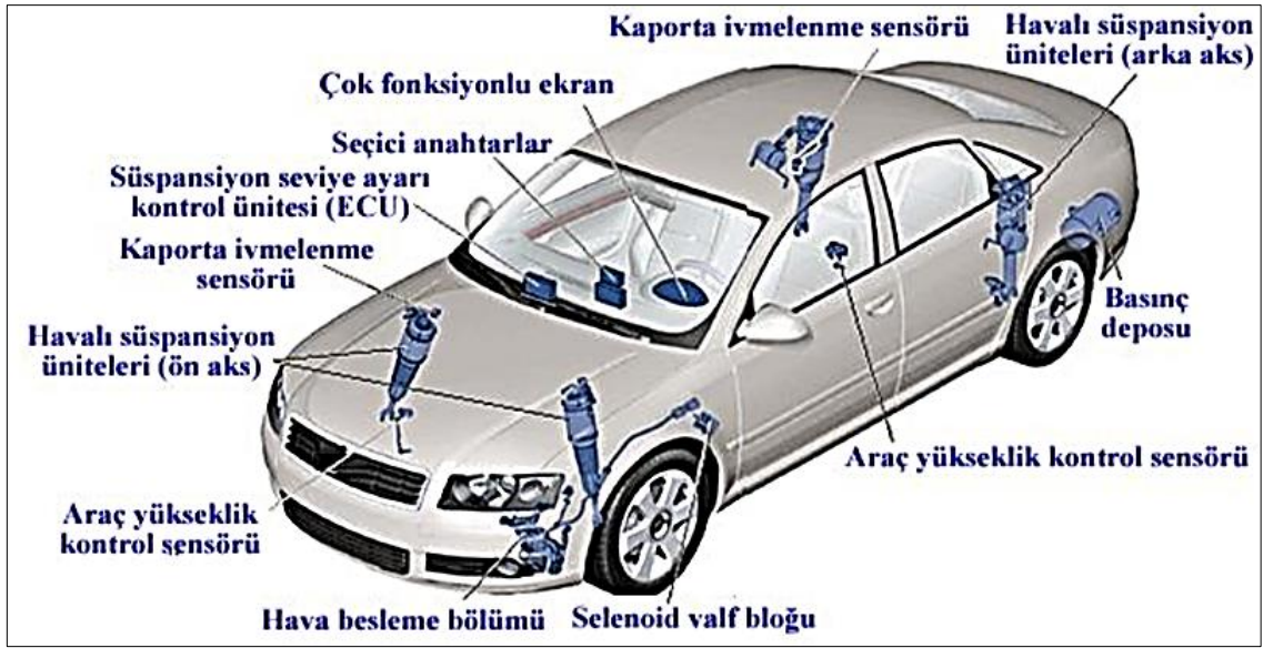
Şekil 2.20. Aktif süspansiyon sistemi gereçlerinin araç üzerindeki yerleri.
