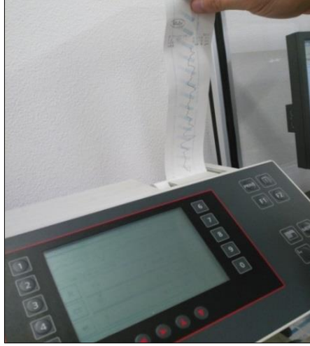
Şekil 4.11. Çıkma testinden sonra pürüzlülük değerlerinin Mahr marka ölçüm cihazı ile ölçülmesi.
