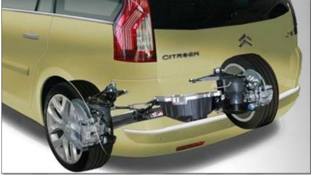
Şekil 2.6. Hidro pnömatik yay örneği [17].
