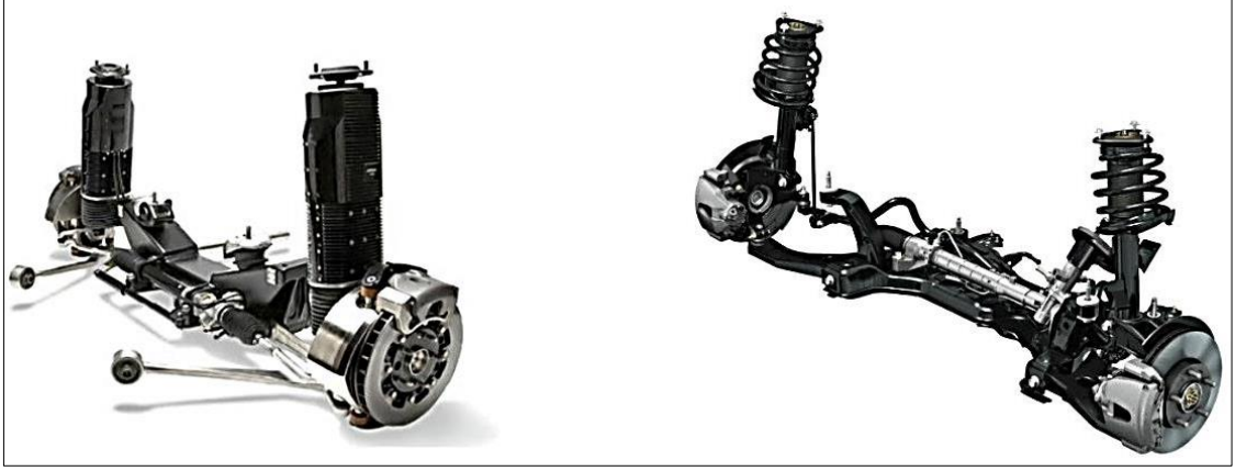
Şekil 2.19. Solda elektromanyetik süspansiyon sistemi – Sağda amortisör ve yaylı geleneksel süspansiyon sistem [41].
