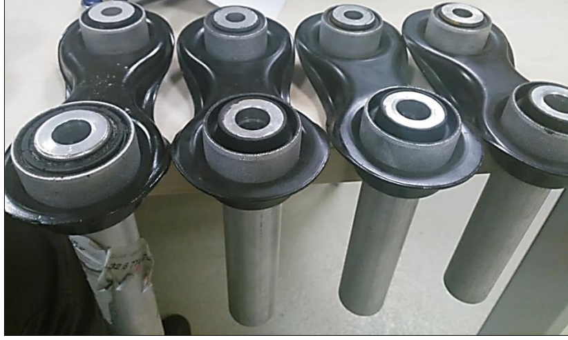
Şekil 4.7. Kumlama işlemi yapılmış ve salıncaklara çakılmış burçlar (B_01).
