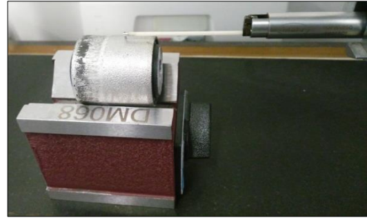
Şekil 4.12. Çıkma testi işleminden sonra pürüzlülük değerlerinin ölçülmesi.
