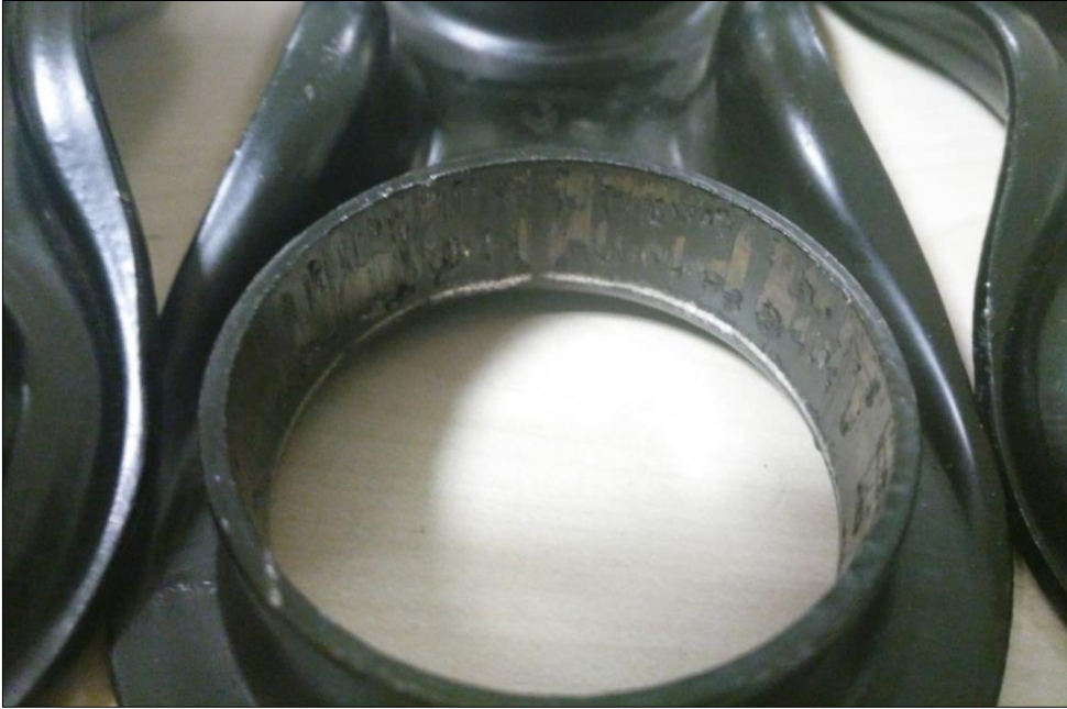
Şekil 4.10. Salıncak denge kolu yatağının burç çıkma testinden sonra yakın yüzey görünümü.
