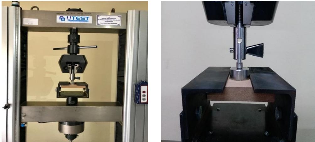
Şekil 3.10. Yapışma direnci deneyinin yapılışı.
