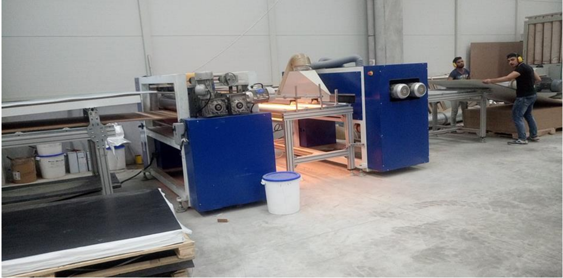
Şekil 1.9. Flat laminasyon poliüretan tutkal sürme ve yapıştırma hattı.
