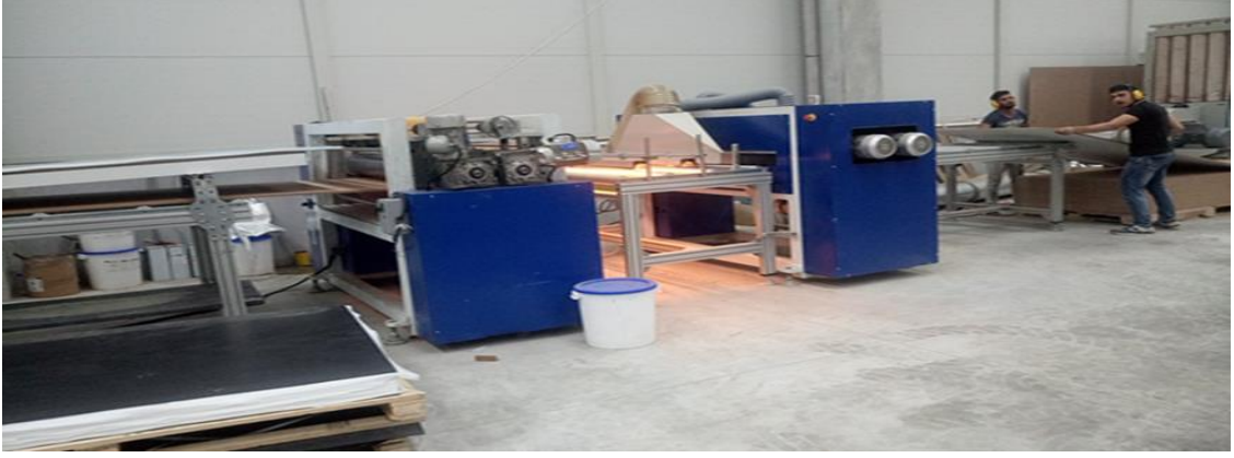
Şekil 3.5. Flat laminasyon tutkallama ve yapıştırma hattı.
