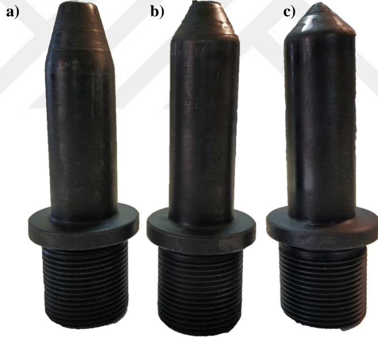
Şekil 4.5. a) 30° konik zımba b) 60° konik zımba c) 90° konik zımba
