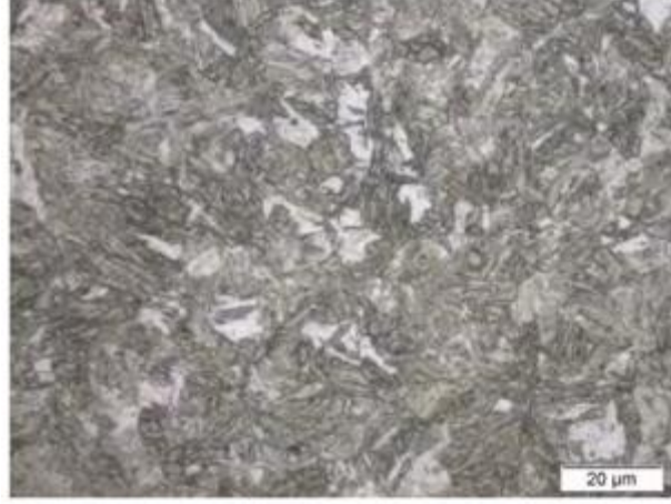
Şekil 3.8. MS çeliğinin iç mikroyapısı [1].
