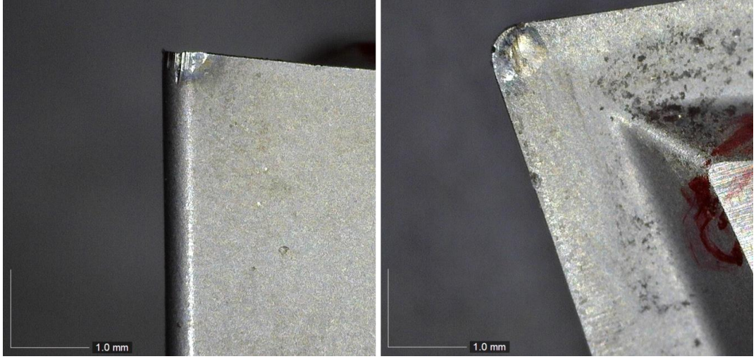
Şekil 5.81. AISI 4340 alaşımlı çeliğin tornalanmasında KİG takımın incelenmesi ( T_x=250\text{ }^{\circ}\text{C} , V_r=185,35\text{ m/dak} , F_r=0,098\text{ mm/dev} ).
