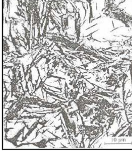
Şekil 3.7. Çeliklerde su verme sonucunda oluşan martenzitik yapı [60].
