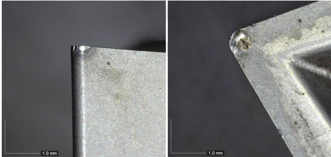
Şekil 5.84. AISI 4340 alaşımlı çeliğin tornalanmasında KİG takımının incelenmesi ( T_x=450\text{ }^{\circ}\text{C} , V_f=185,35\text{ m/dak} , F_f=0,098\text{ mm/dev} ).
