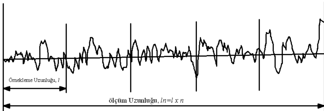
Şekil 3.20. Örnekleme uzunluğu ve sayısı ile ölçüm uzunluğu [82].
