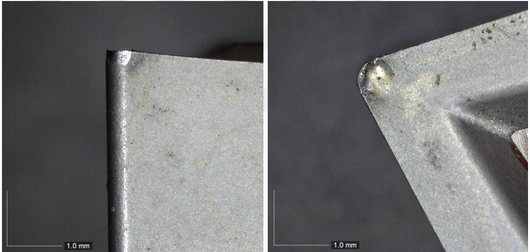
Şekil 5.82. AISI 4340 alaşımlı çeliğin tornalanmasında KSZ takımın incelenmesi ( T_x=250\text{ }^{\circ}\text{C} , V_r=185,35\text{ m/dak} , F_r=0,098\text{ mm/dev} ).
