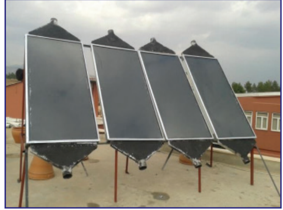
Şekil 3. Camlı güneş kolektörü [5]
