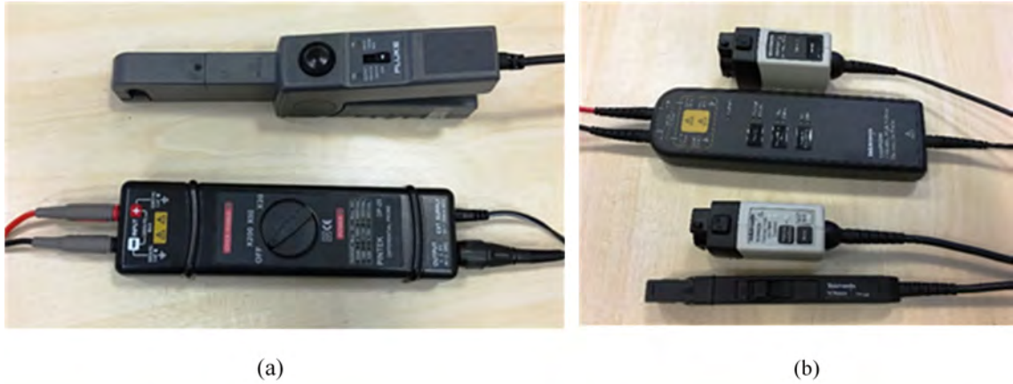
Şekil 3.12. a) Pintek DP25 diferansiyel prob ve Fluke 80i10s akım probu, b) Tektronix THDP0200 diferansiyel prob ve Tektronix TCP0020 akım probu.
