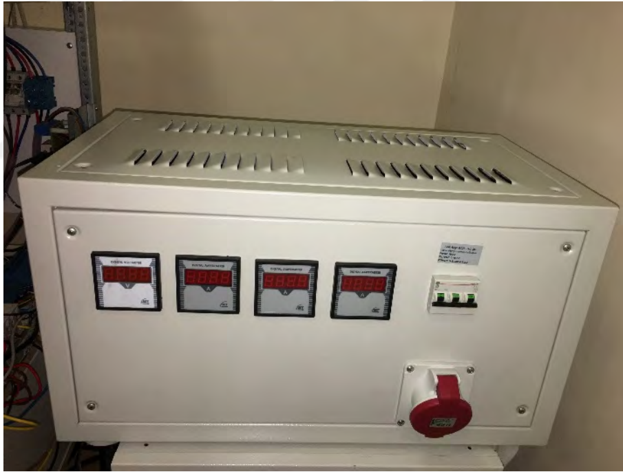
Şekil 3.6. 3-fazlı 10 kVA varyak fotoğrafı.
