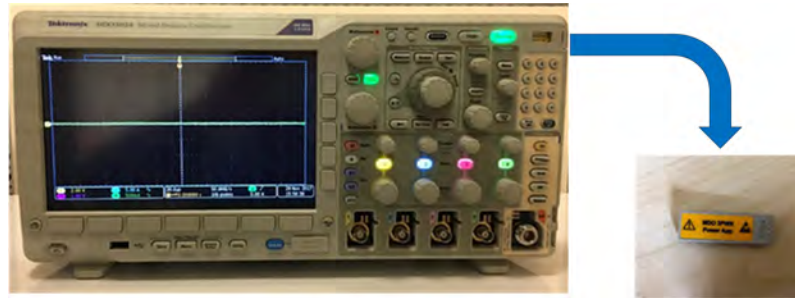
Şekil 3.10. Tektronix MDO3024 4-kanallı 200 MHz sayısal osiloskop ve MDO3PWR güç ölçüm ve analiz uygulama modülü.
