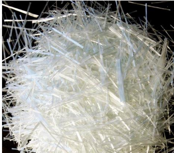
Şekil 3.4. AR kırılmış 12 mm cam elyaf.
