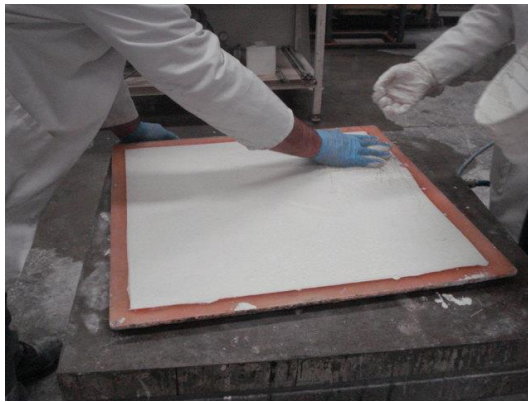
Şekil 3.15. Numunelerin premiks yöntem ile üretimi.
