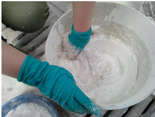
Şekil 3.8. Cam elyafların harca ilave edilmesi.
