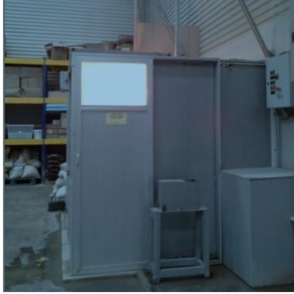
Şekil 3.19. Isıtma-yağmur etkisi deney kabini.
