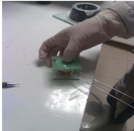
Şekil 3.10. Le Chatelier cihazına yerleştirilen numune.
