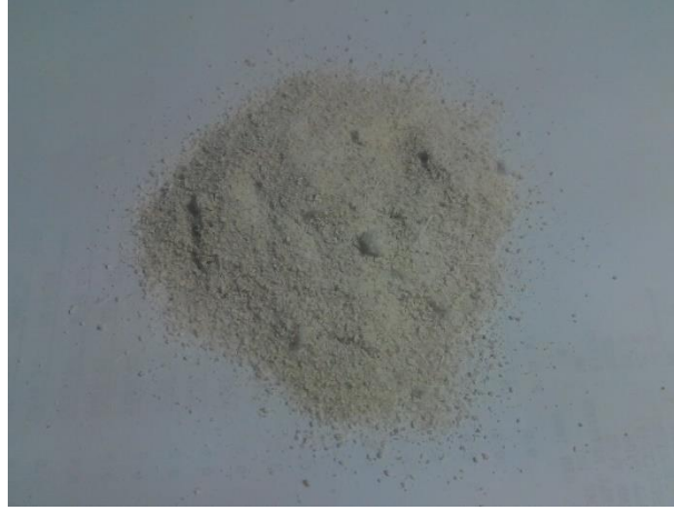
Şekil 3.3. Atık GRC ürünlerinden elde edilen numune.
