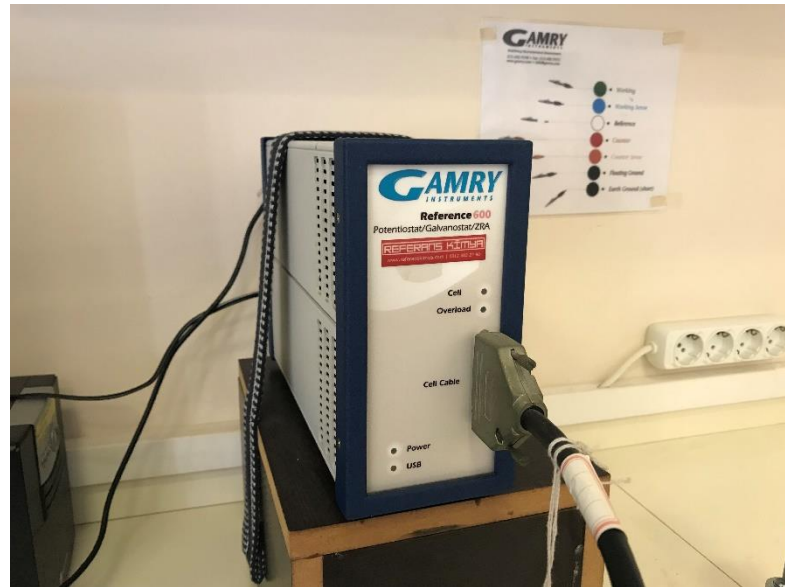
Şekil 2.5. GAMRY Referans 600 potentiostat/galvanostat/ZRA.
