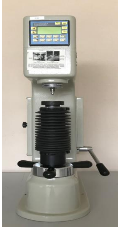
Şekil 2.3. DIGIROCK-RB Brinell sertlik deęeri ölçüm cihazı.
