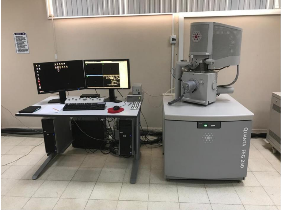
Şekil 2.7. J. Quanta FEG 250 EDS SEM analiz cihazı.
